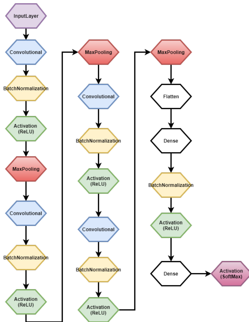
Figura 18 – Representação da estrutura da CNN utilizada.
