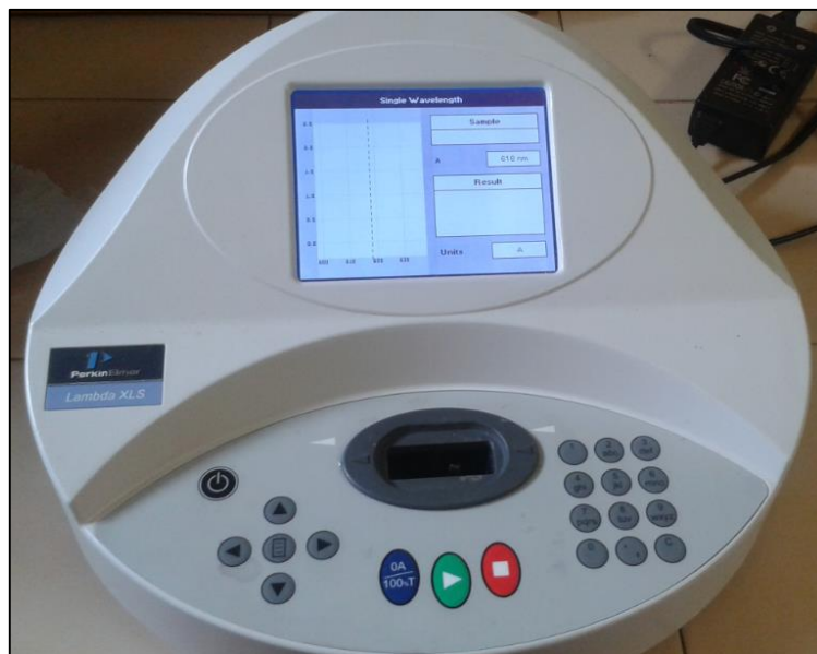
Figura 7 - Espectrofotômetro de absorção molecular UV-Vis de feixe simples (marca PerkinElmer)
