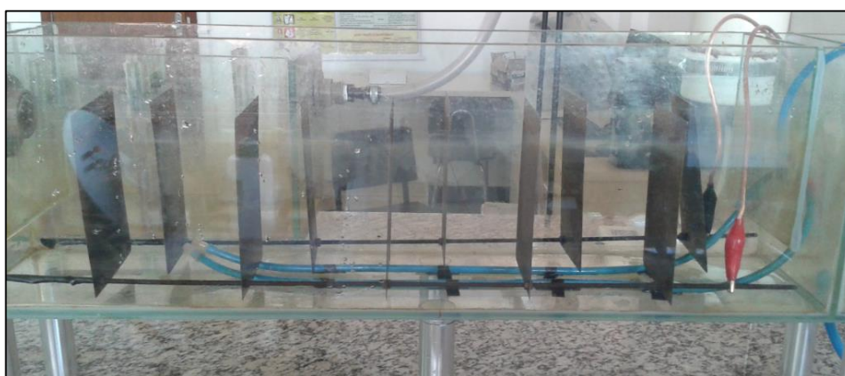
Figura 6 - Montagem experimental no módulo eletrolítico para o tratamento por eletrofloculação com injeção de ar comprimido
