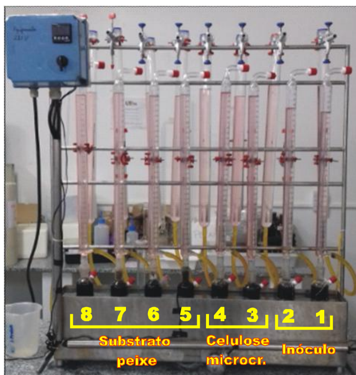
Figura 3 - Sistema experimental final com os 8 eudiômetros em um banho termostático.
