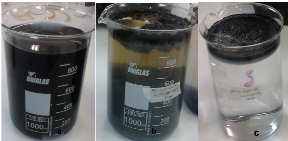
Figura 12 - (a) Solução Bruto (b) Solução Após a EF, Utilizando Eletrodo de Ferro; (c) Eletrodo de Alumínio
