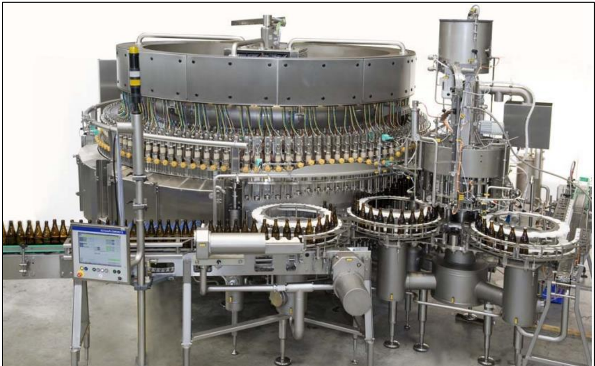
Figura 6 – Esquema de uma máquina enchedora circular Fonte – Blüml e Fischer (2009)
