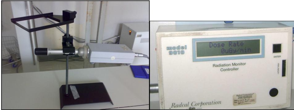
**Figura 14:** Câmara de ionização e monitor.
