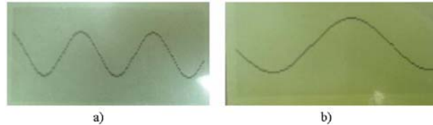
Figura 69 – Ondas sonoras mostradas no display LCD. a) Onda com frequência de 3 kHz e pressão sonora de 80dB; b) Onda com frequência de 1,5 kHz e pressão sonora de 80dB.
