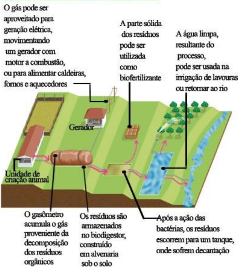
Figura 20 – Esquema de funcionamento do biodigestor
