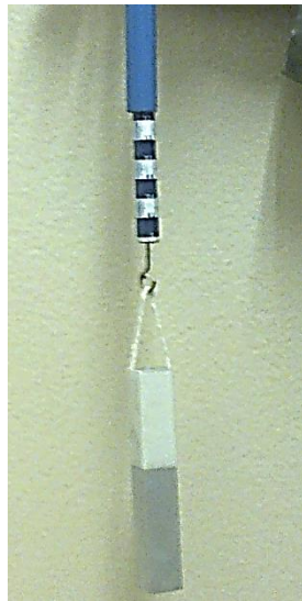
Figura 02: O dinamômetro de 2N
