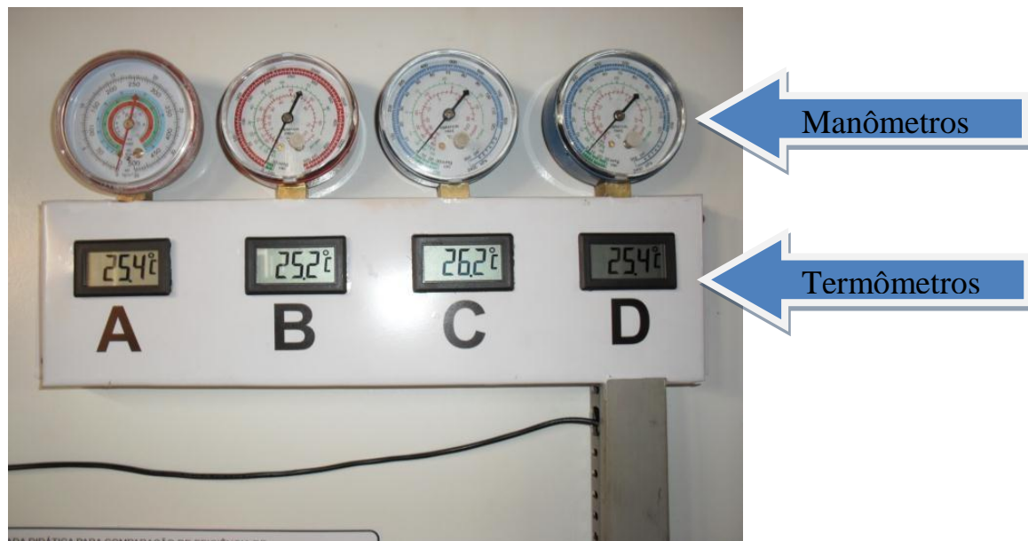
Figura 8 - Manômetros de alta e baixa e termômetros digitais.
