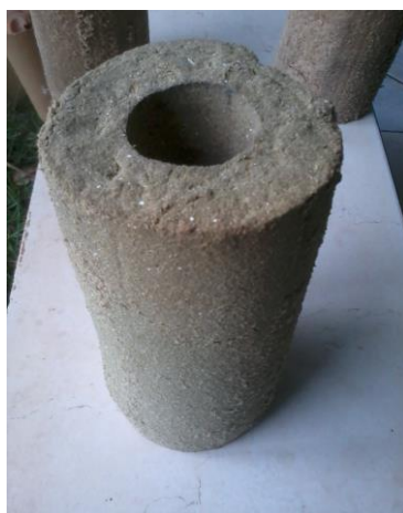
Figura 17: Briquete mistura 2x1 com prensagem de 300 kgf/cm 2 Fonte: Os autores
