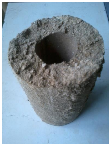
Figura 15: Briquete mistura 5x1 com prensagem de 200 kgf/cm 2 Fonte: Os autores
