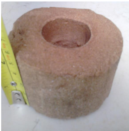
Figura 18: Briquete mistura 2x1 com prensagem de 300 kgf/cm 2 Fonte: Os autores
