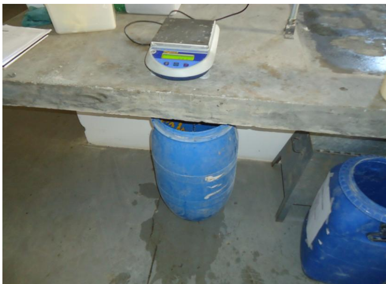
Figura 33 - Montagem do sistema da balança hidrostática Fonte: A autoria própria.
