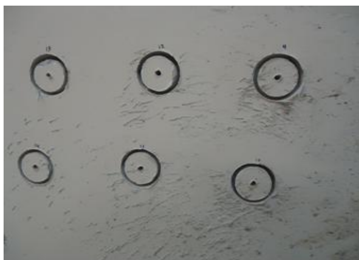
Figura 29 - Demarcação dos pontos utilizados para o ensaio de resistência à tração Fonte: Autoria própria.
