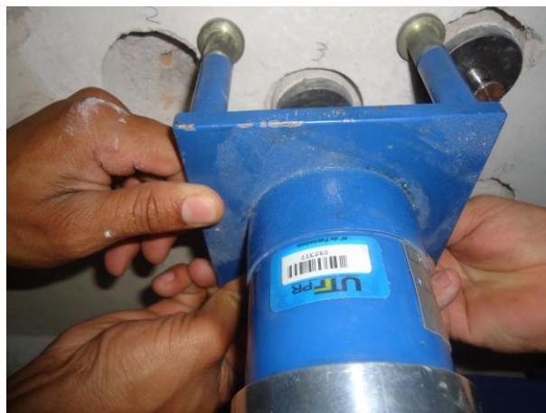
Figura 31 - Equipamento utilizado para retirar as amostras fixadas na parede Fonte: Autoria própria.
