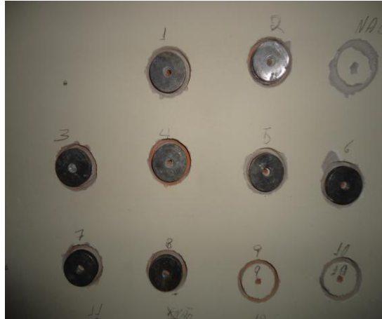
Figura 30- Fixação das pastilhas na parede com adesivo epóxi Fonte: Autoria própria.
