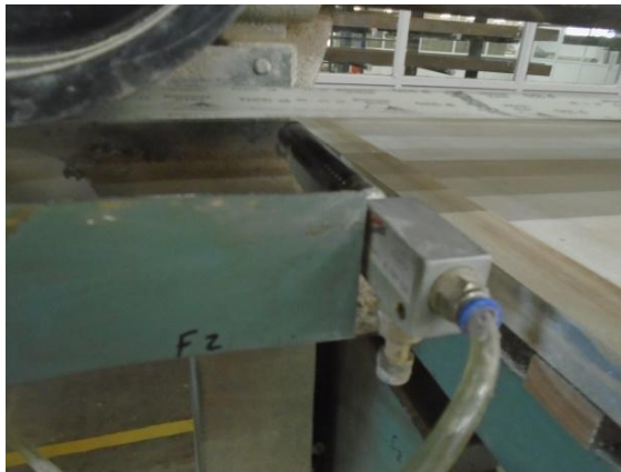
Figura 11:tubo de limpeza da lixa Fonte: Gabriel da Silva
