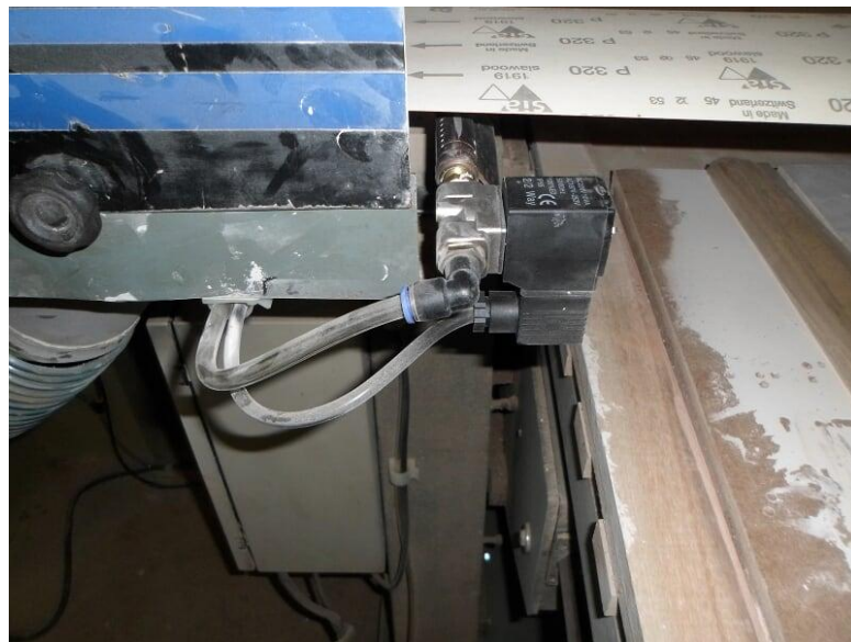
Figura 21: Sistema de limpeza da lixa. Fonte: Gabriel da Silva.
