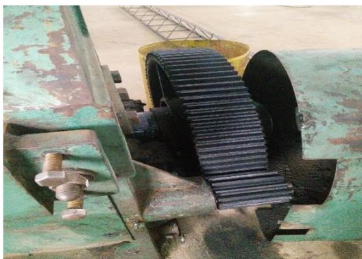
**Figura 15 Proteção Fixa Das Engrenagens**
