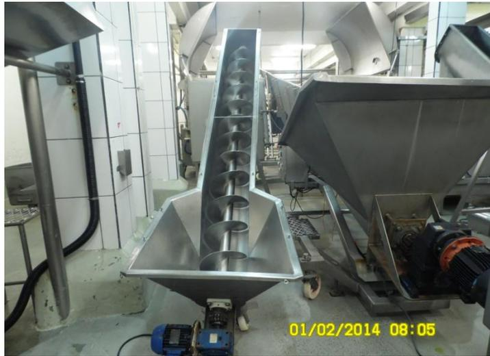
**Figura 11 Transportadora Helicoidal em Desacordo com a NR-12**
