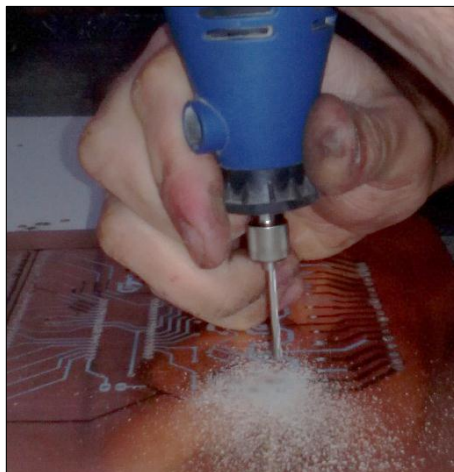
Figura 24- Perfuração de terminais Fonte: Autoria própria
