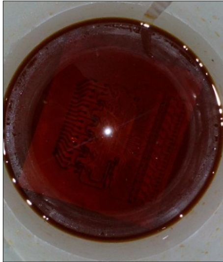
Figura 25 - Corrosão de placa em Perclorato de ferro Fonte: Autoria própria
