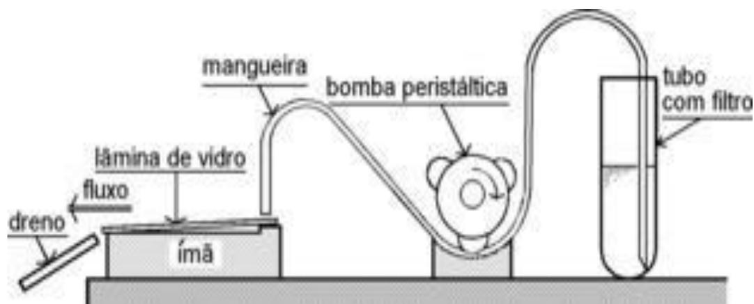
**Figura 11 - Ferrografo analítico**
