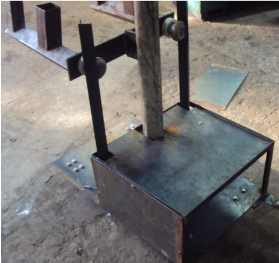
Figura 23 – Guias de nylon apoiando na cantoneira Fonte: Própria
