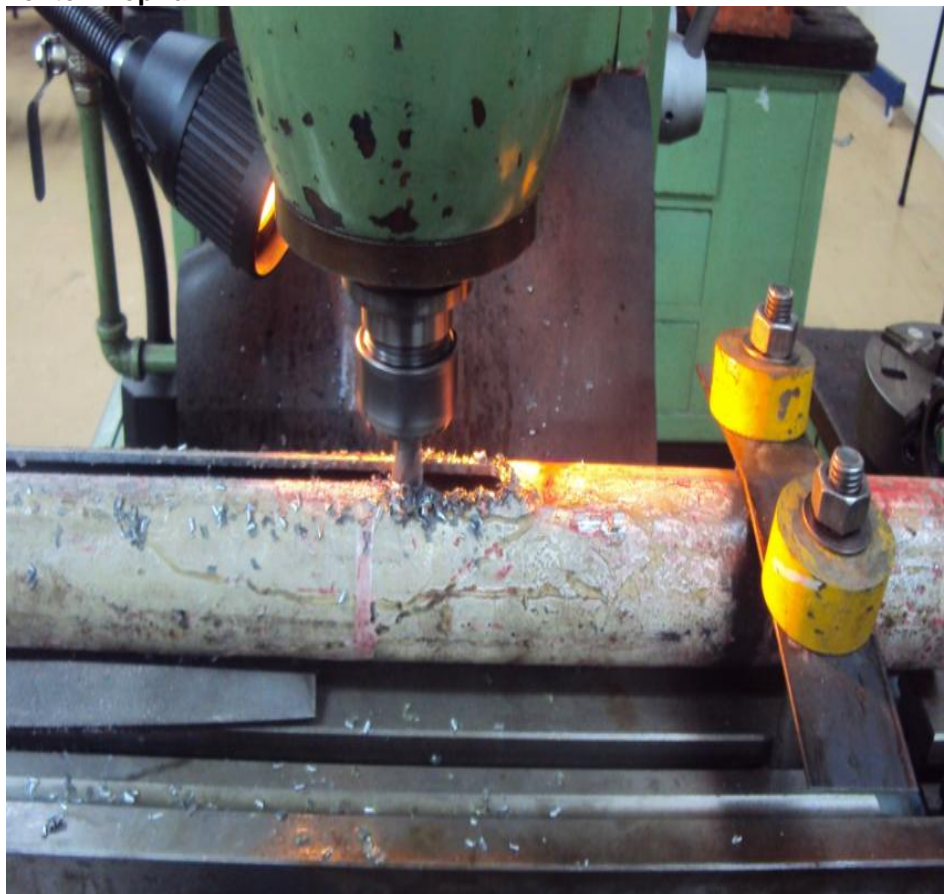
Figura 7 – Finalizando rasgo no tubo Fonte: Própria
