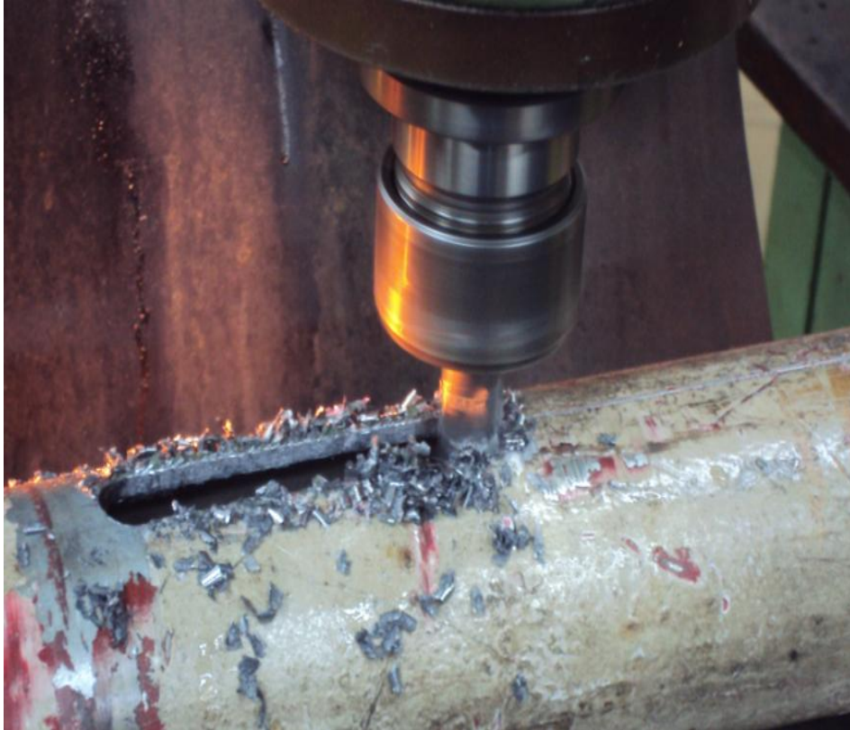
Figura 6 – Abrindo rasgo no tubo Fonte: Própria
