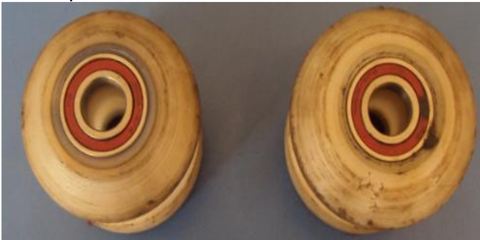
Figura 24 – Guias de nylon com rolamentos Fonte: Própria
