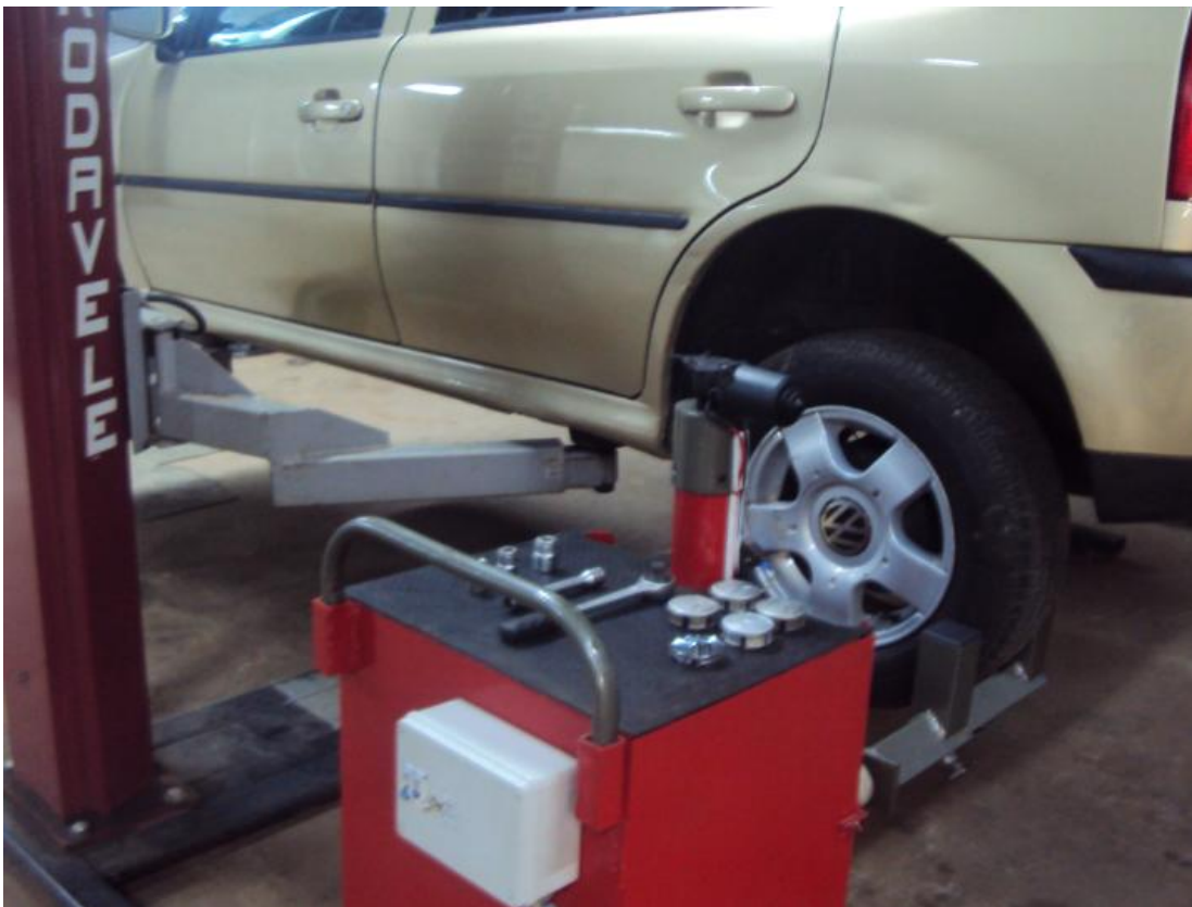
Figura 34 – Retirada roda Fonte: Própria
