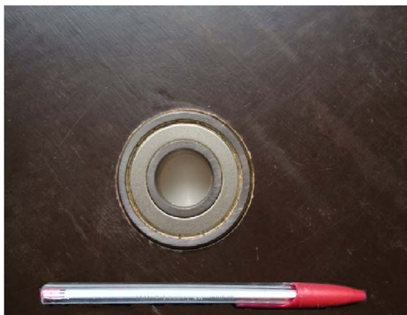
Figura 12 – Rolamento blindado do tipo esfera fixo na placa de MDF. Fonte: Aatoria própria, 2013.
