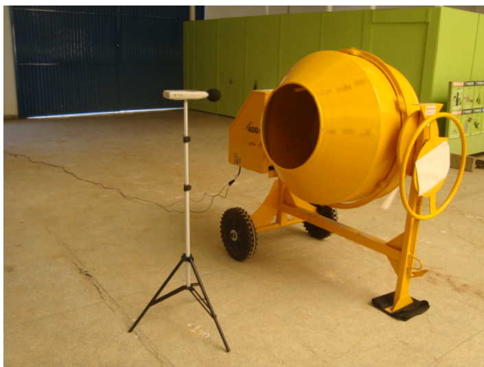
Figura 17 – Coleta do nível de pressão sonora equivalente frontal a uma distância de 1m do centro da betoneira Fonte: Autoria própria, 2013.
