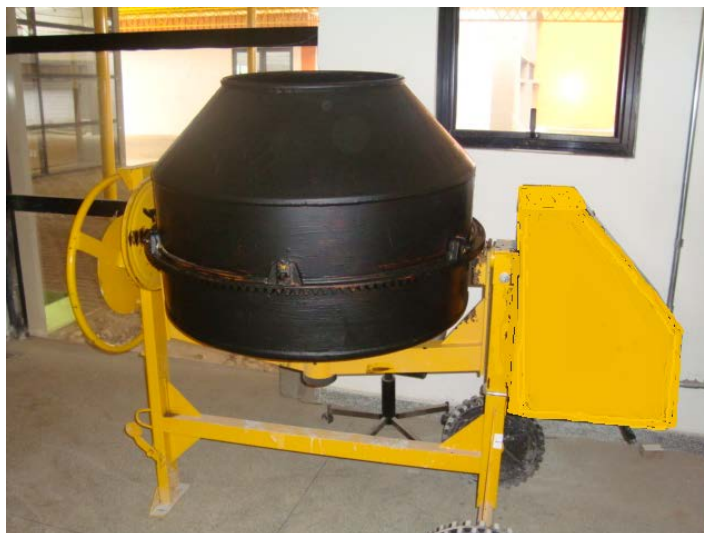
Figura 11 – Betoneira revestida com borracha líquida, material Tipo “B”. Fonte: Aatoria própria, 2013.
