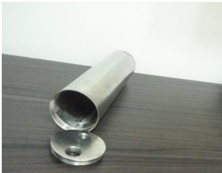
Figura 11 – Reator de aço inoxidável utilizado para produção de carvão Fonte: Autoria própria
