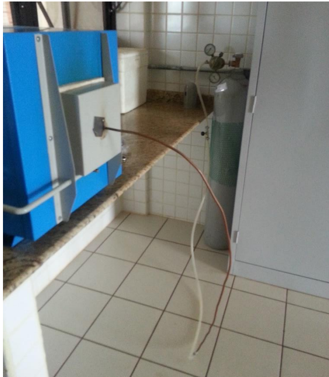
Figura 12 – Mufla com adaptação na tampa para entrada de gás nitrogênio Fonte: Autoria própria
