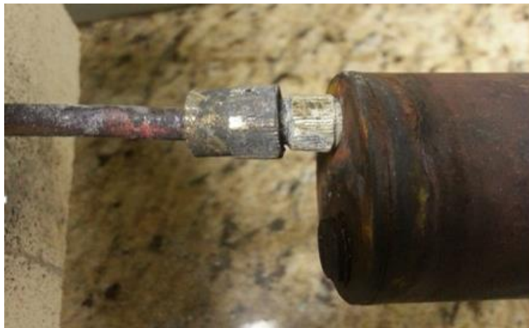
Figura 13 – Conector do tubo de cobre e do reator de aço inoxidável Fonte: Autoria própria
