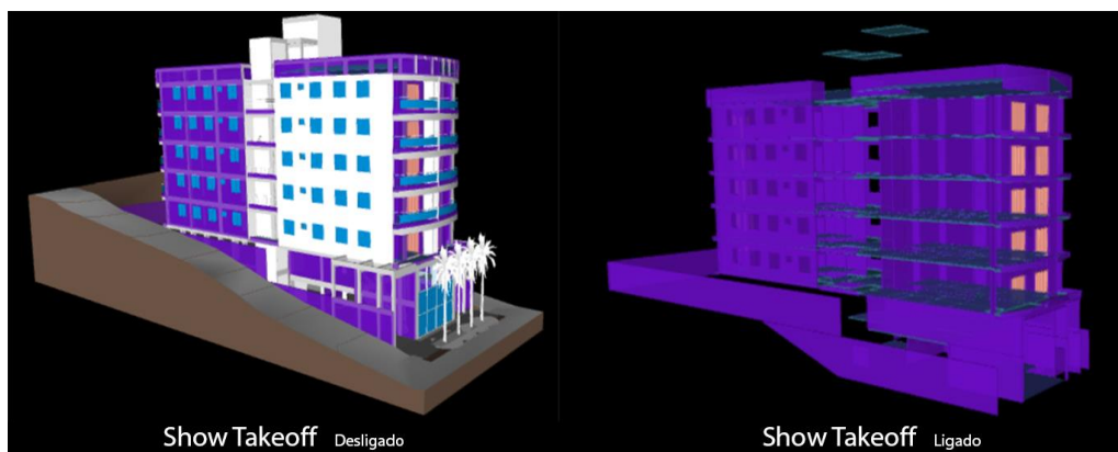
Figura 45 - Ferramenta Show e Hide Takeoff. Fonte: Autor (Extraído do software NAVISWORKS)
