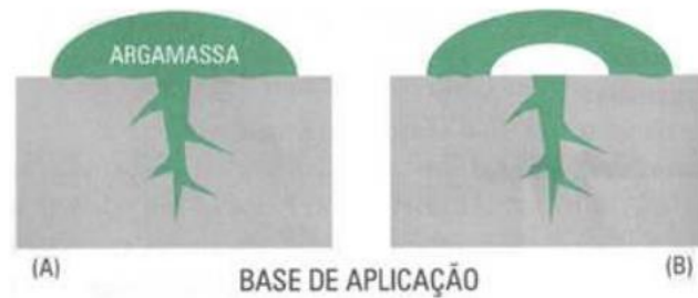
Figura 2 - (a) Argamassa com boa aderência inicial; (b) Perda de aderência inicial por descontinuidade da argamassa.
