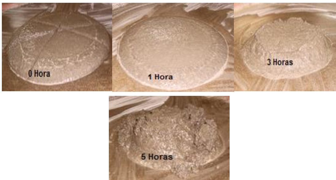
Figura 22 - Espalhamento da areia de britagem com incorporador de ar com o passar das horas.
