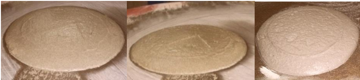
Figura 20 - (a) Areia de Britagem (b) areia natural e (c) argamassa estabilizada
