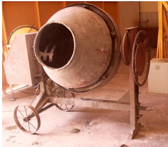
Figura 11 - Betoneira de eixo inclinado com capacidade de 320 litros.
