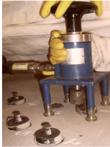
Figura 16 - Equipamento de arrancamento à tração.
