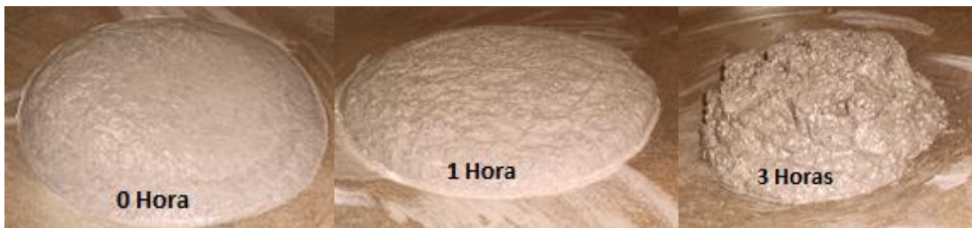
Figura 21 - Espalhamento da areia de britagem com o passar das horas
