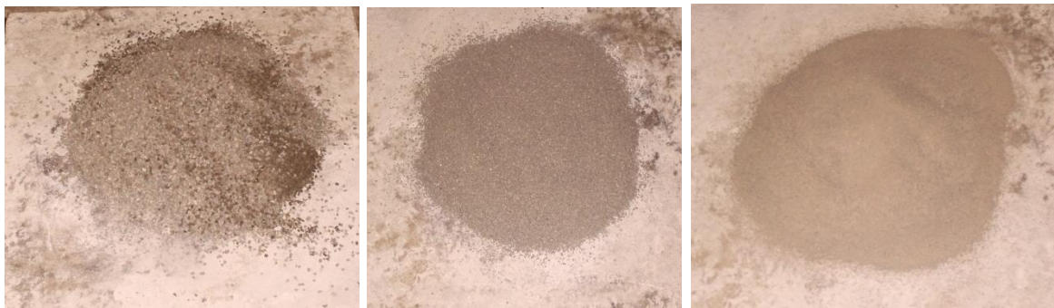
Figura 6 - (a) Descartado (b) Chapisco (c) emboço.
