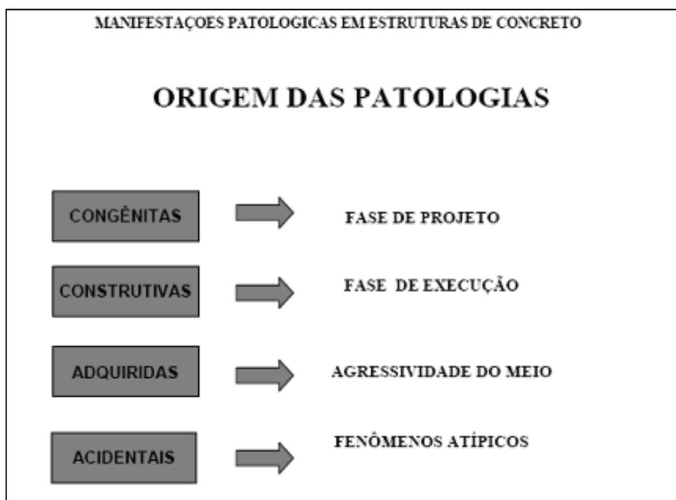
**Figura 9 - Origens das patologias em estrutura de concreto**
