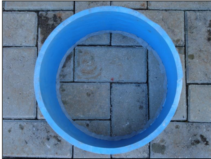
Figura 19: Cilindro instalado para o teste de infiltração Fonte: Autor (2013)
