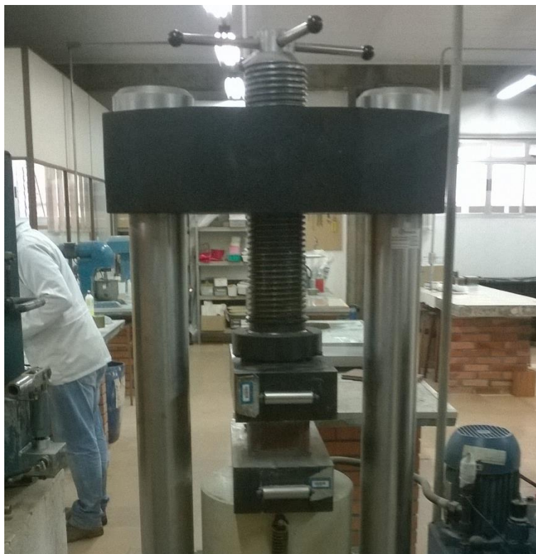
Figura 35: Ensaio de resistência à compressão Fonte: do Autor (2017).
