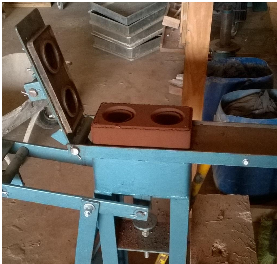
Figura 30: Moldagem de um bloco de solo-cimento corrigido com areia natural Fonte: do Autor (2017).
