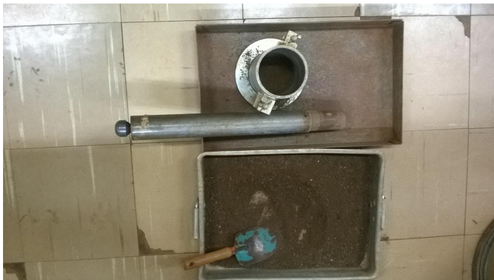
Figura 26: Solo-cimento sendo compactados Fonte: do Autor (2017).
