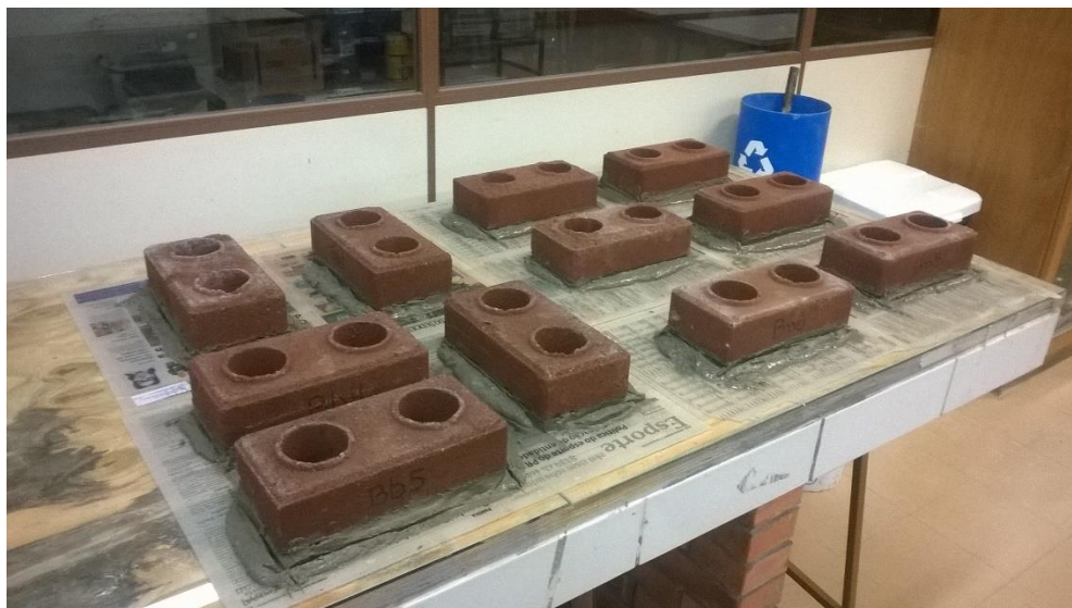
Figura 33: Capeamento da primeira face dos blocos Fonte: do Autor (2017).
