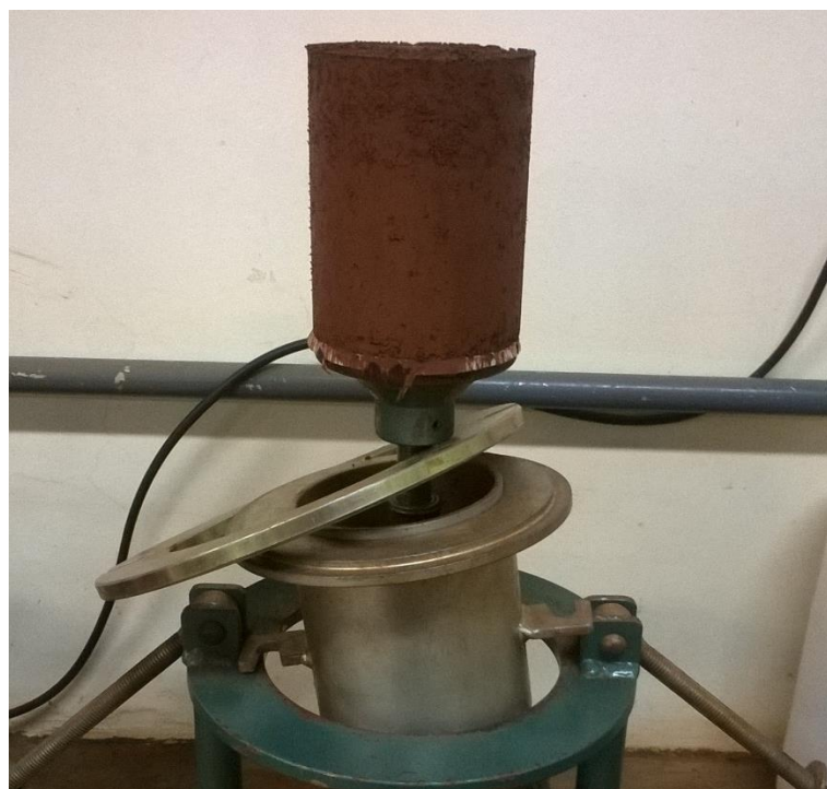
Figura 27: Cilindro de solo-cimento compactado Fonte: do Autor (2017).
