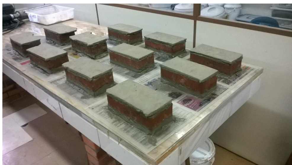
Figura 34: Capeamento da segunda face dos blocos Fonte: do Autor (2017).
