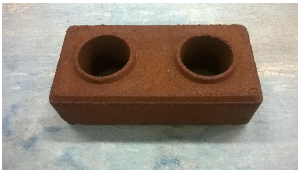
Figura 32: Bloco de solo-cimento corrigido com areia natural após a curado Fonte: do Autor (2017).
