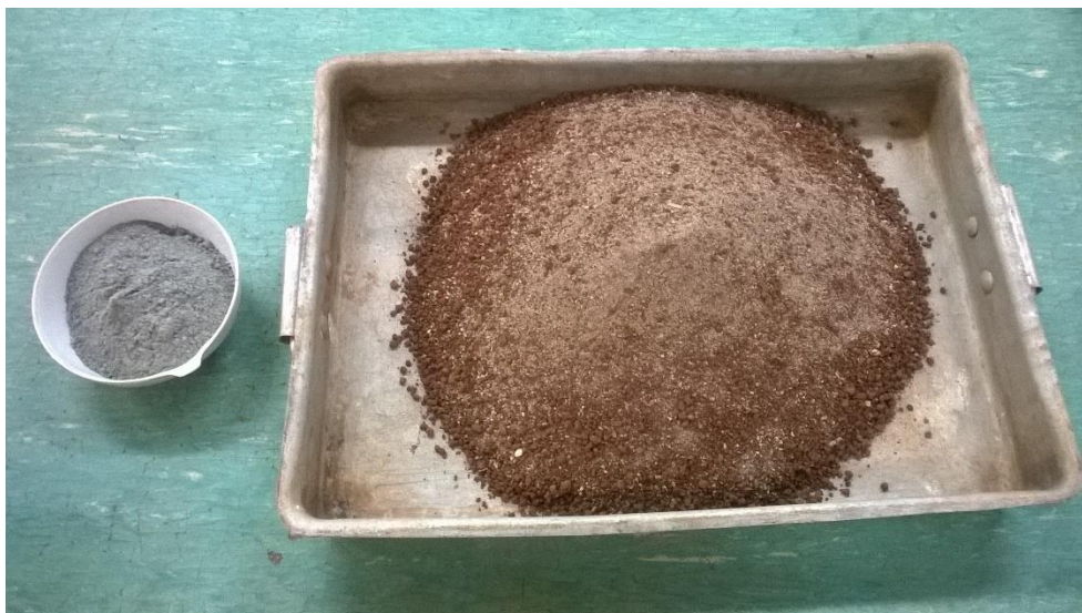
Figura 24: Preparação da mistura de solo corrigido e cimento Fonte: do Autor (2017).
