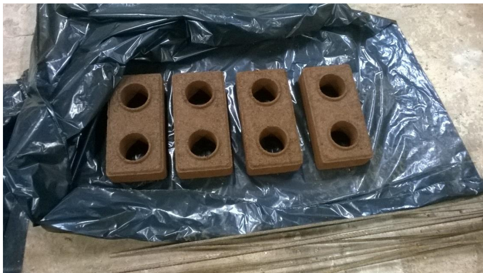
Figura 31: Cobrimento dos blocos corrigidos com areia de britagem para sua cura Fonte: do Autor (2017).
