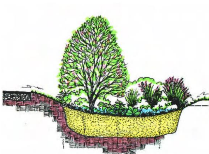
Figura 11 - Dispositivo de biorretenção Fonte: Prince George's County, 2007.
