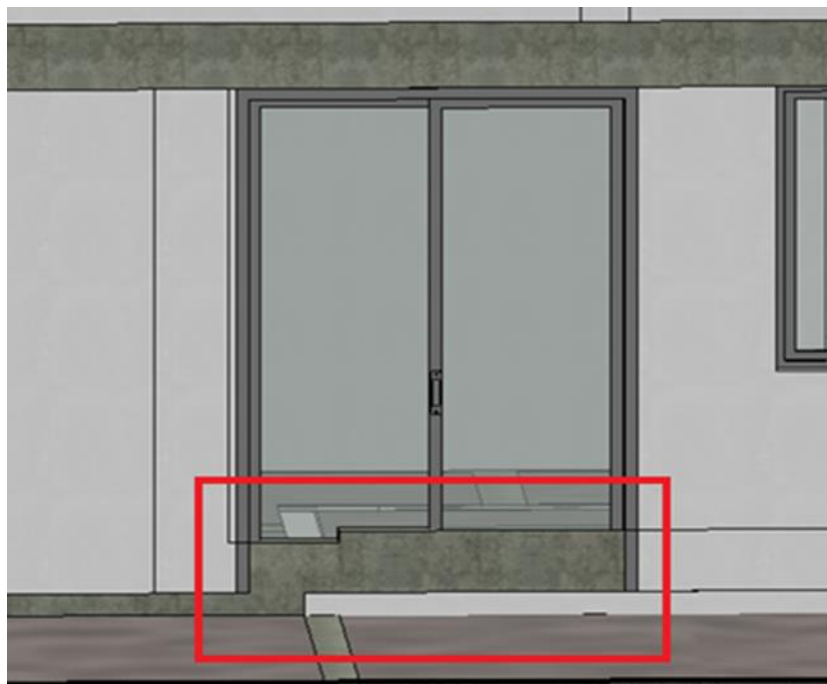
Figura 60 – Detalhe degrau de 38 cm entre as lajes Fonte: Autor (2018)
