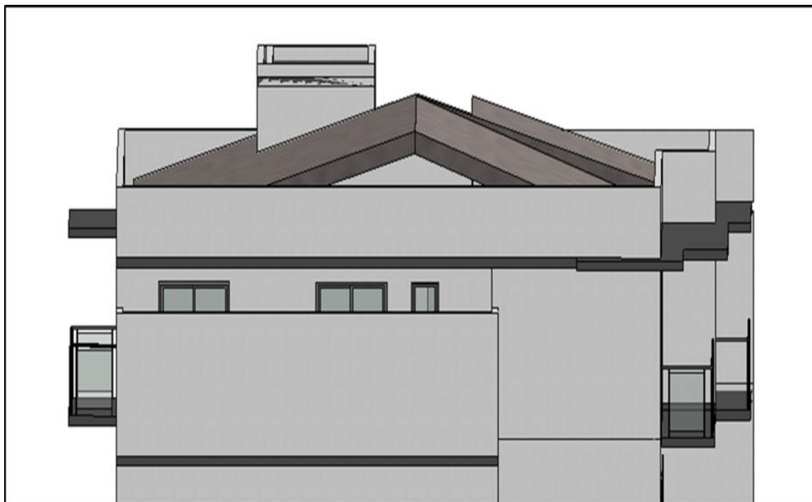
Figura 38 – Cobertura com inclinação de 25% Fonte: Autor (2018)
