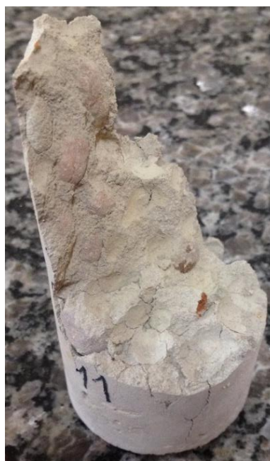
Figura 32 - Corpo de prova ensaiado a 900°C após ruptura Fonte: acervo do autor.
