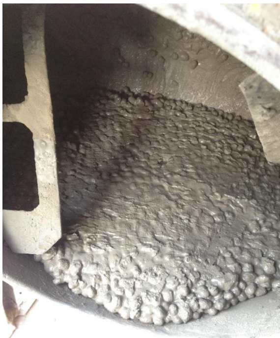
Figura 14 - Concreto sem adição de fibras Fonte: acervo do autor.
