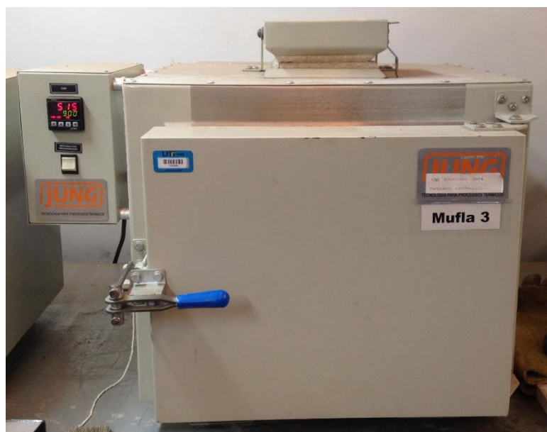
Figura 18 - Mufla utilizada nos ensaios de simulação de incêndio Fonte: acervo do autor.
