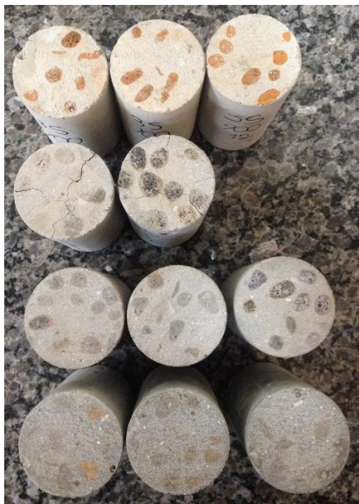
Figura 23 - Diferença na coloração dos corpos de prova em relação a temperatura, para o traço B sem fibras Fonte: acervo do autor.
