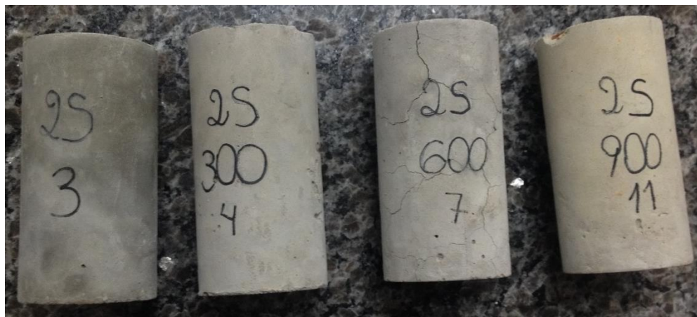
Figura 27 - Fissuração nos corpos de prova sem adição de fibras, em relação ao aumento da temperatura
