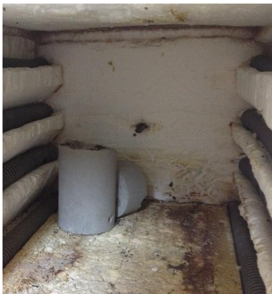
Figura 25 - Corpo de prova após ruptura por spalling dentro da mufla Fonte: acervo do autor.
