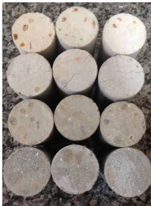
Figura 24 - Diferença na coloração dos corpos de prova em relação a temperatura, para o traço B com fibras Fonte: acervo do autor.
