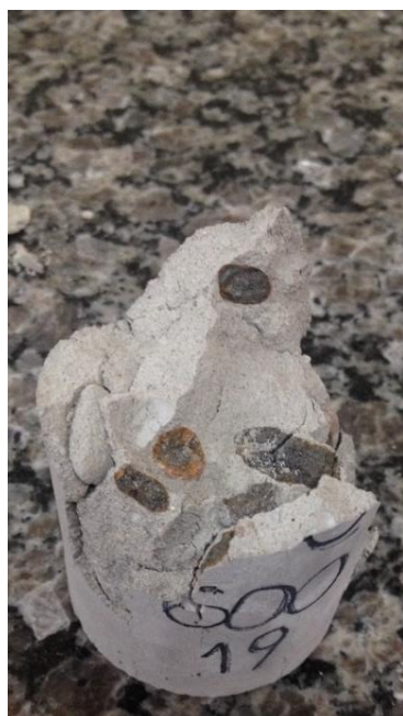
Figura 31 - Corpo de prova ensaiado a 600°C após ruptura Fonte: acervo do autor.
