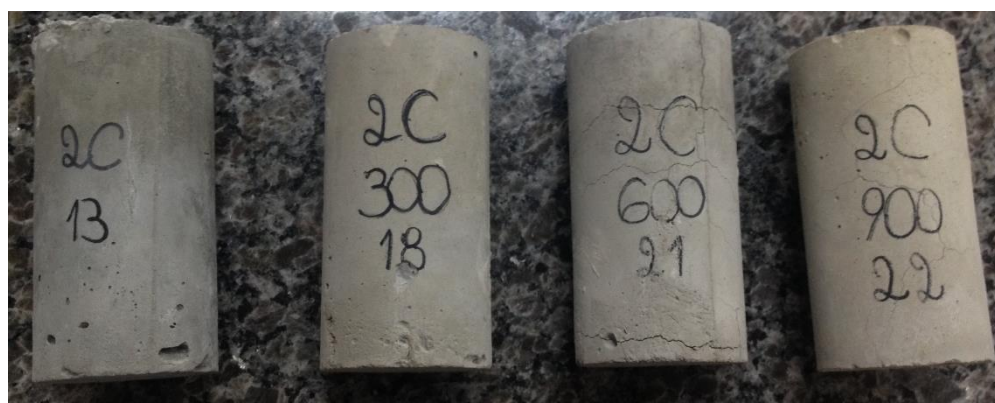
Figura 28 - Fissuração nos corpos de prova com adição de fibras, em relação ao aumento da temperatura
