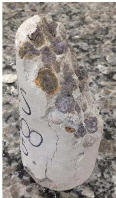
Figura 30 - Corpo de prova ensaiado a 300°C após ruptura Fonte: acervo do autor.
