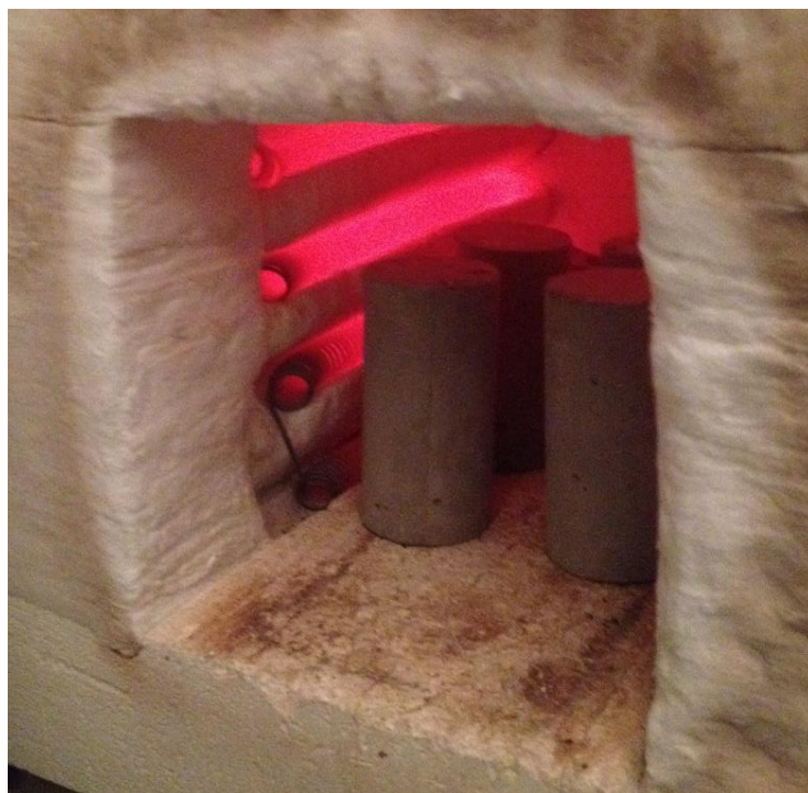
Figura 20 – Interior da mufla com os corpos de prova a temperatura de 600°C Fonte: acervo do autor.
