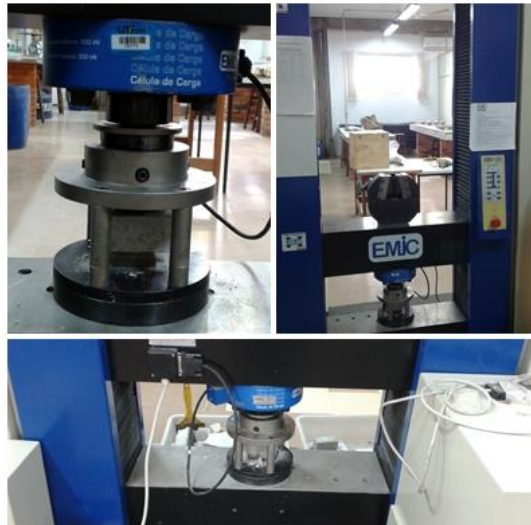
Figura 23 - Rompimento argamassas testes Fonte: (AUTORIA PRÓPRIA, 2017).
