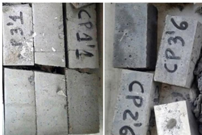
Figura 27 - Corpos de prova de argamassa partidos ao meio pelo ensaio de tração na flexão Fonte: (AUTORIA PRÓPRIA, 2017).
