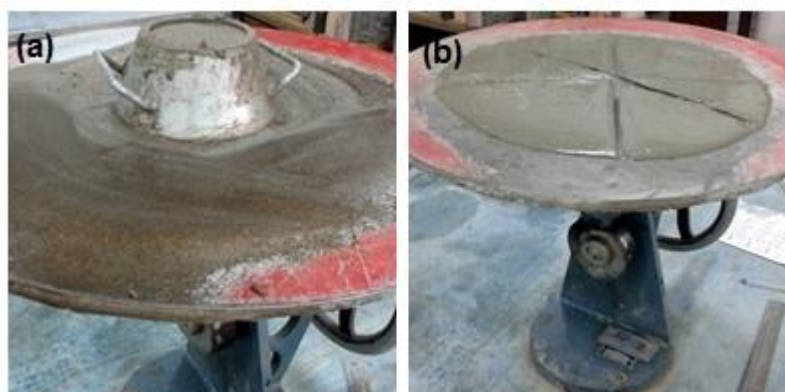
Figura 19 - Índice de consistência. (a) Tronco de cone preenchido de argamassa. (b) Espalhamento Fonte: (AUTORIA PRÓPRIA, 2017).
