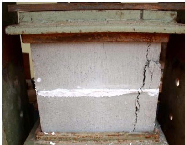
Figura 2 - Ensaio de compressão de prismas Fonte: (POLITÉCNICA ENGENHARIA, 2017).
