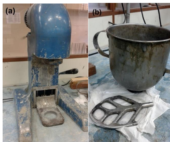
Figura 18 - (a) Misturador mecânico Pavitest. (b) Cuba de aço (capacidade de 5 litros) e pá de metal Fonte: (AUTORIA PRÓPRIA, 2017).
