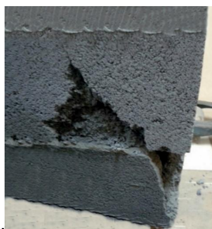
Figura 51 - P2'1, colapso do bloco inferior Fonte: (AUTORIA PRÓPRIA, 2017).
