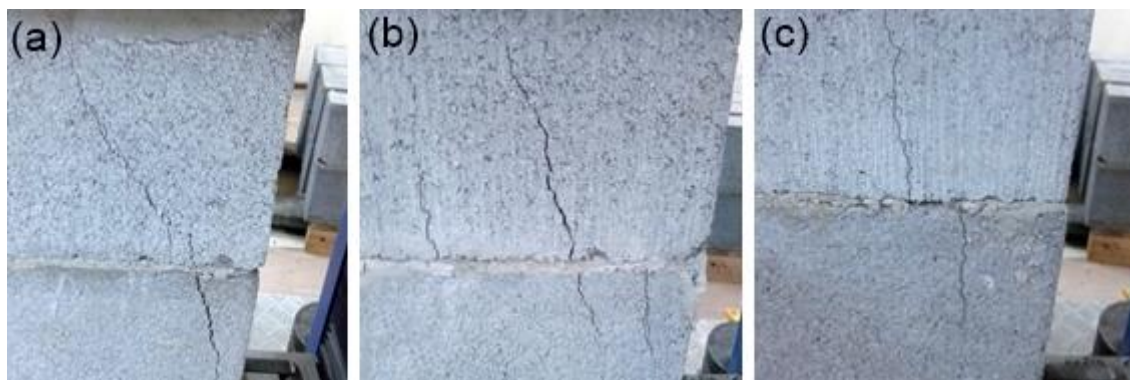
Figura 32 - Ruptura dos prismas. (a) P2'1 (traço 1). (b) P1'2 (traço 2). (c) P3'6 (traço 6) Fonte: (AUTORIA PRÓPRIA, 2017).
