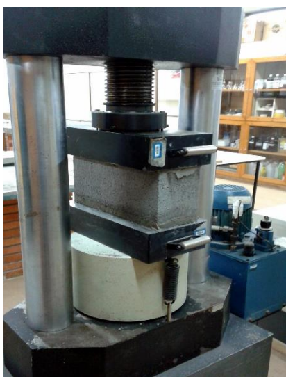
Figura 15 - Ensaio de compressão axial dos blocos Fonte: (AUTORIA PRÓPRIA, 2017).
