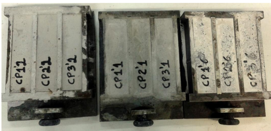
Figura 24 - Argamassa moldadas Fonte: (AUTORIA PRÓPRIA, 2017).
