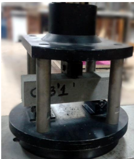
Figura 26 - Ensaio de tração na flexão das argamassas Fonte: (AUTORIA PRÓPRIA, 2017).
