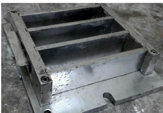
Figura 20 - Molde prismático de argamassa Fonte: (AUTORIA PRÓPRIA, 2017).
