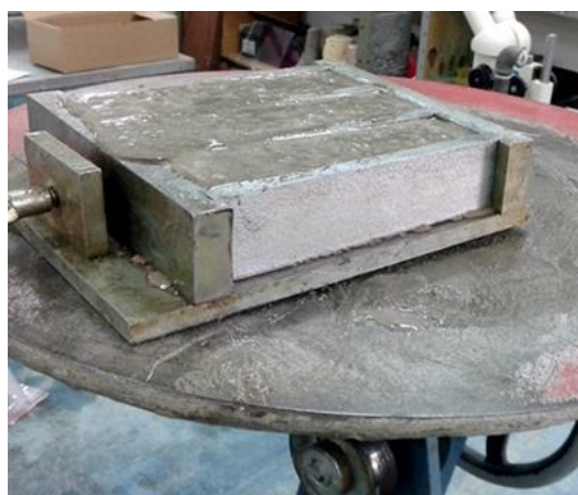
Figura 21 - Moldagem das argamassas Fonte: (AUTORIA PRÓPRIA, 2017).
