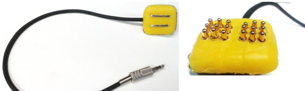
Figura 34 - Eletrodos diferenciais de prata e pinos retráteis de ouro confeccionados para testes em animais.
