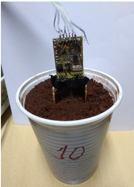
Figura 26 - Eletrodos de sonda inseridos no solo de uma amostra durante o teste de medição Fonte: Autoria Própria
