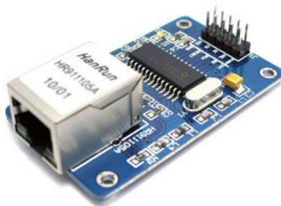
Figura 25 – Interface de rede. Fonte: BRASILROBOTICS, 2013.
