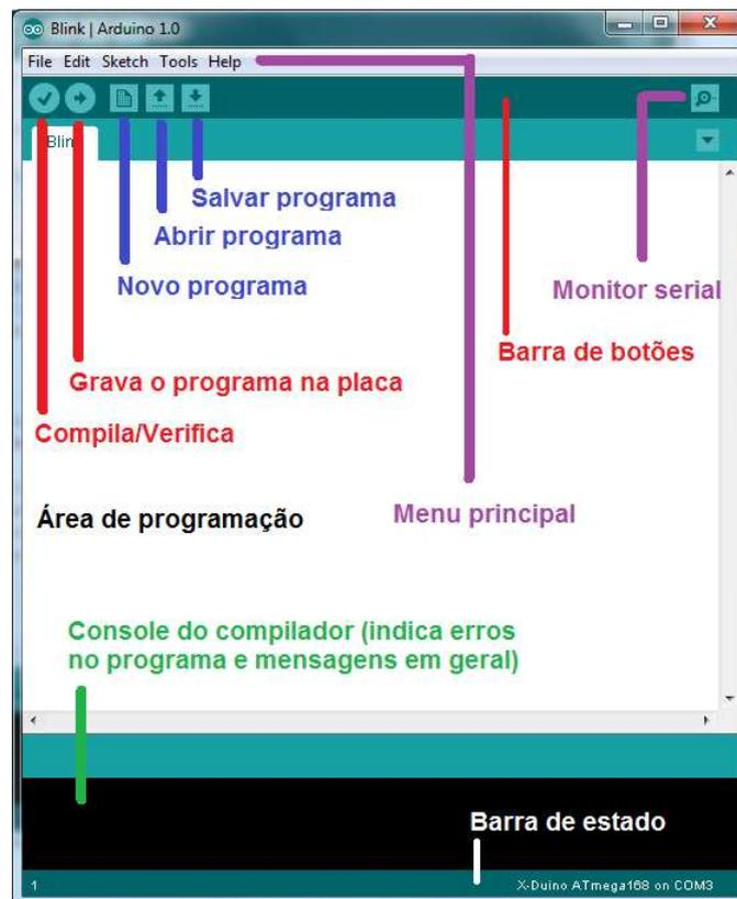
**Figura 34: Interface de trabalho da ferramenta © Energia**
