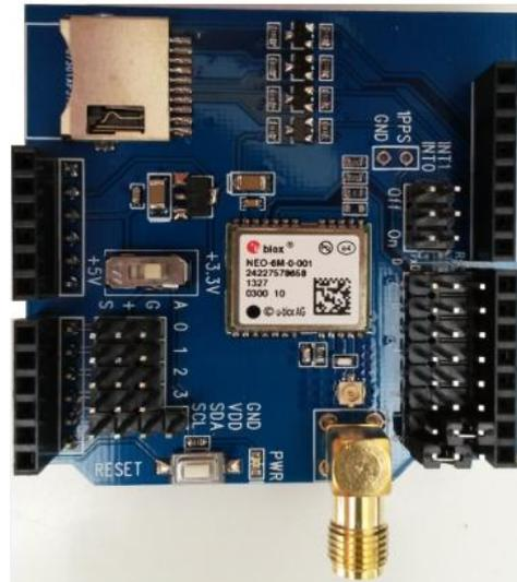
**Figura 12 – Módulo GPS NEO-6M**
