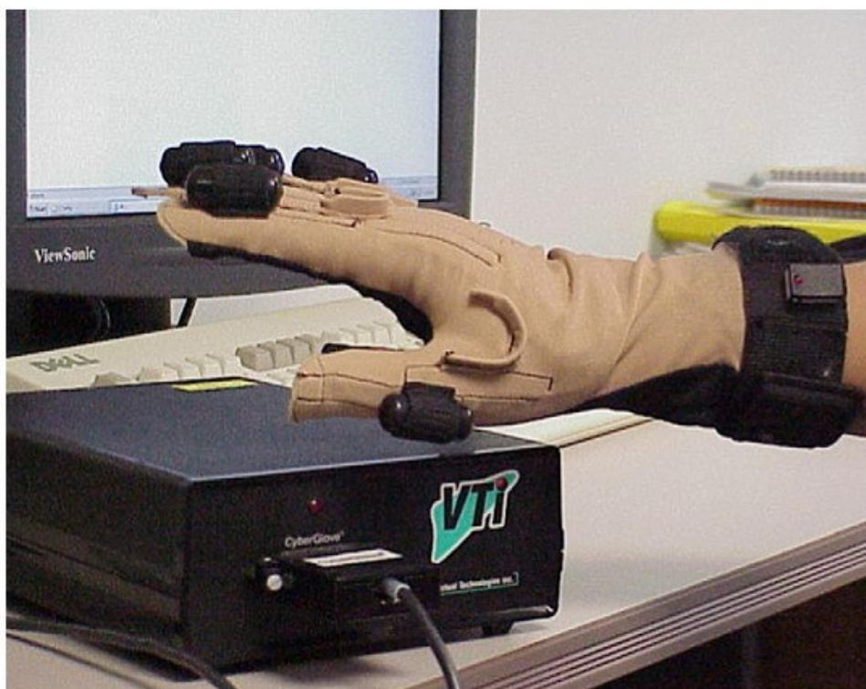
**Figura 8 - CyberGlove com 18 sensores.**
