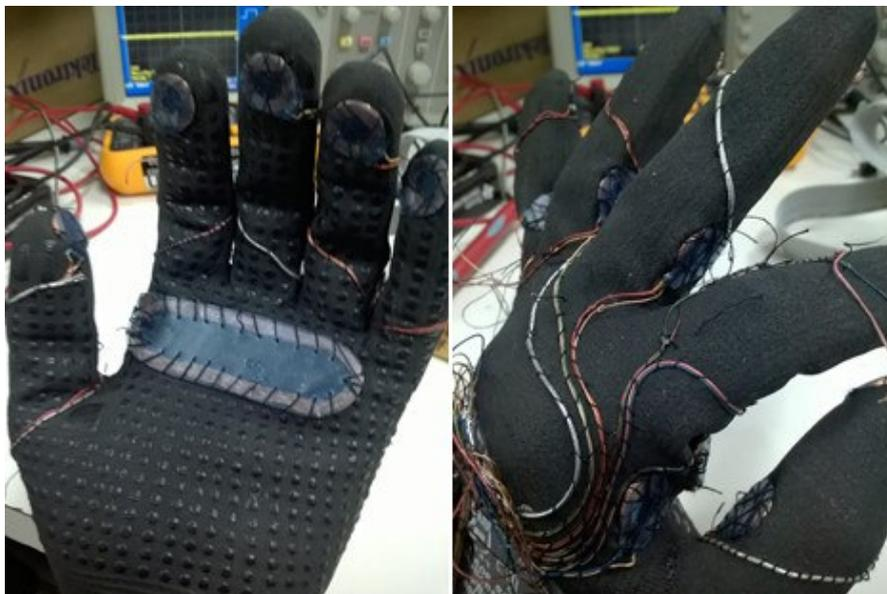
**Figura 38 - Vista frontal e lateral da luva sensora desenvolvida.**
