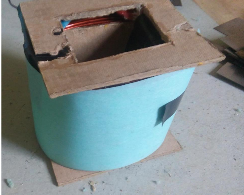
Figura 17 – Carretel com enrolamentos de cobre.
