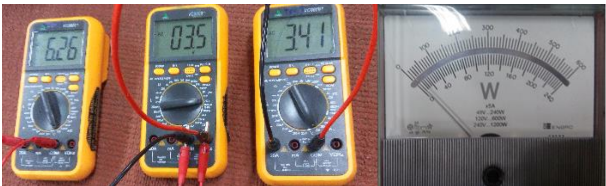
Figura 28 – Ensaio de curto-circuito no transformador com enrolamentos de alumínio.
