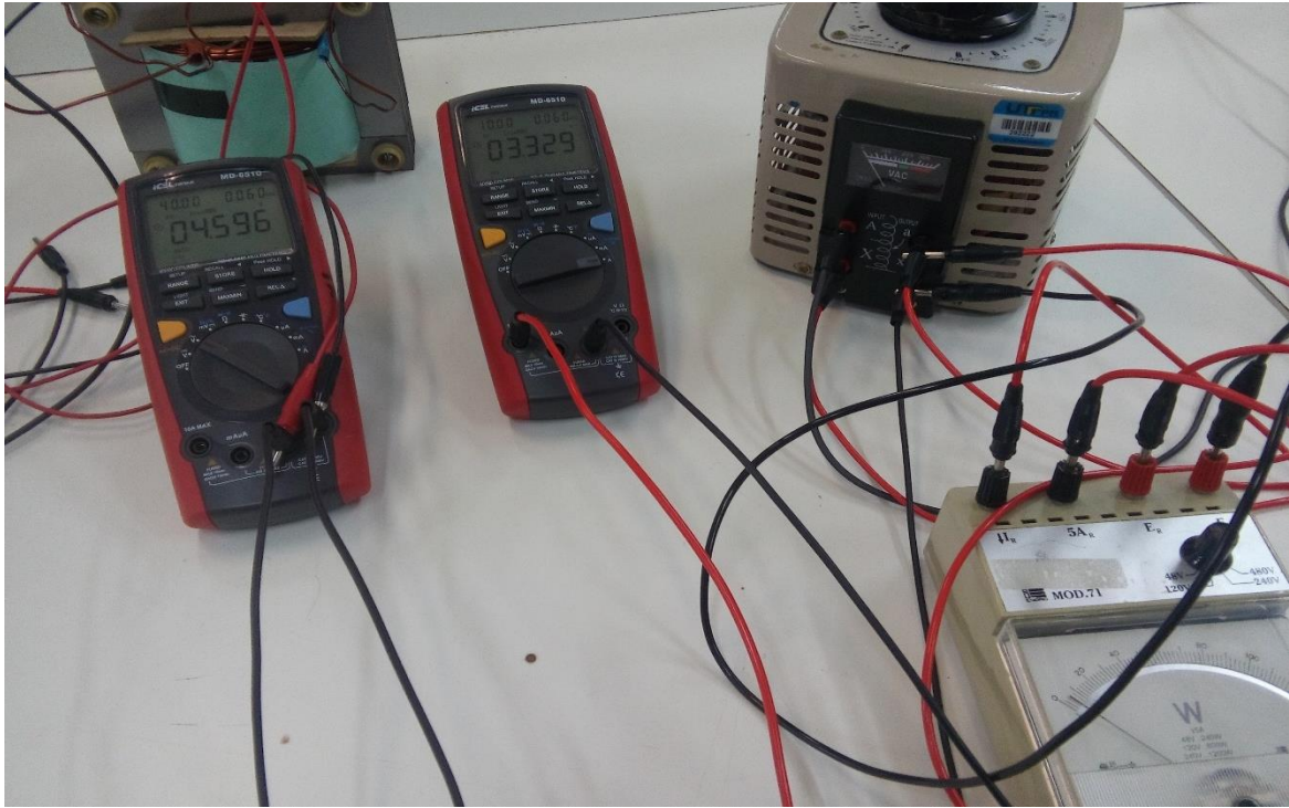
Figura 25 – Ensaio de curto-circuito no transformador com enrolamentos de cobre.
