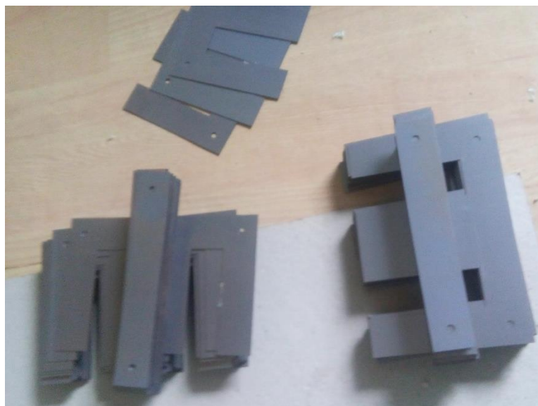
Figura 16 – Contagem e separação das lâminas do núcleo para o transformador com enrolamentos de cobre.
