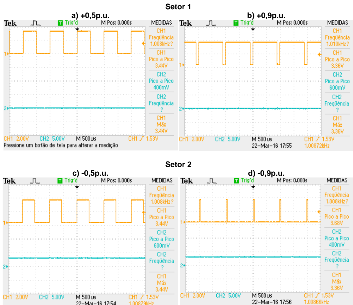
Figura 43 - PWM1 e PWM2 aplicados ao inversor monofásico - Sequência braço fixo. Canal 1 (amarelo): sinal para chave S1, Canal 2 (azul): sinal para chave S3. Referências de tensão: a) 0,5 p.u. positivo, b) 0,9 p.u. positivo, c) 0,5 p.u. negativo, d) 0,9 p.u. negativo.
