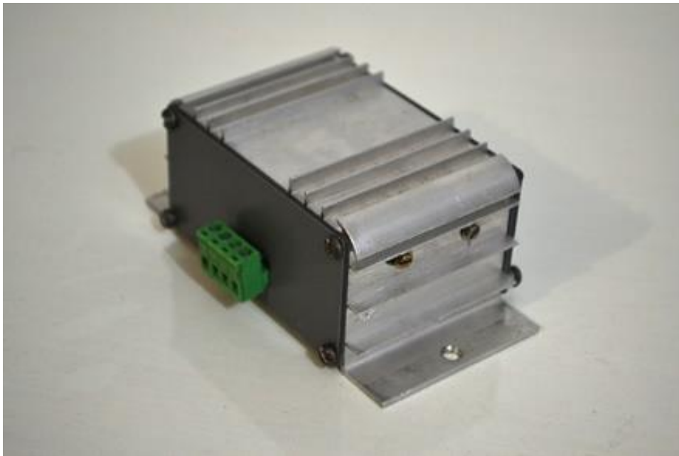
Fotografia 1 - Inversor monofásico ponte completa Fonte: Autoria Própria
