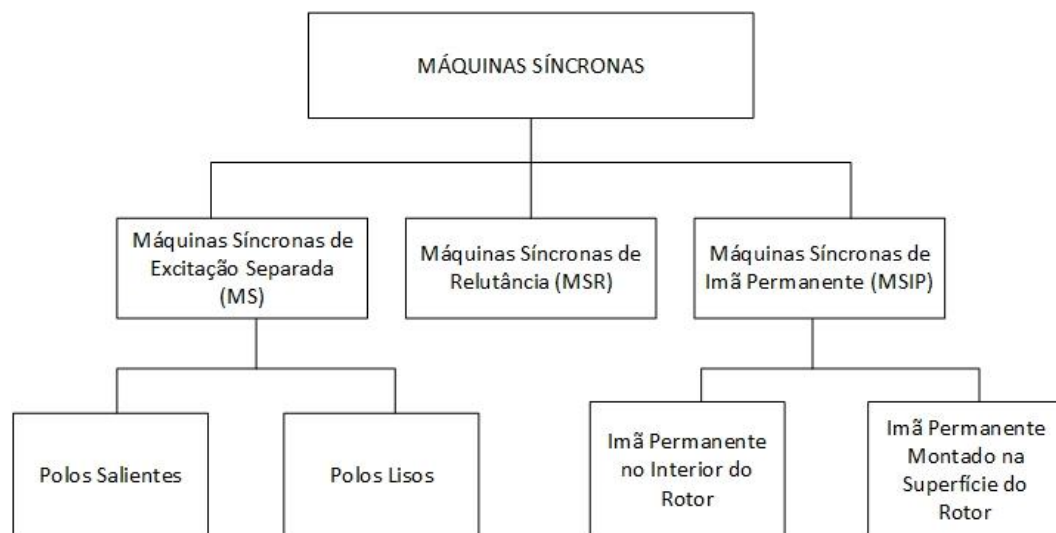
Figura 12 - Tipos de máquinas síncronas. Fonte: Extraído e adaptado de (KIMPARA, 2012) .
