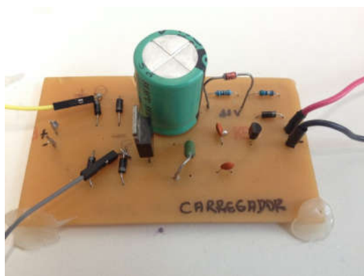
Figura 41 – PCI carregador de baterias. Fonte: Autoria própria.
