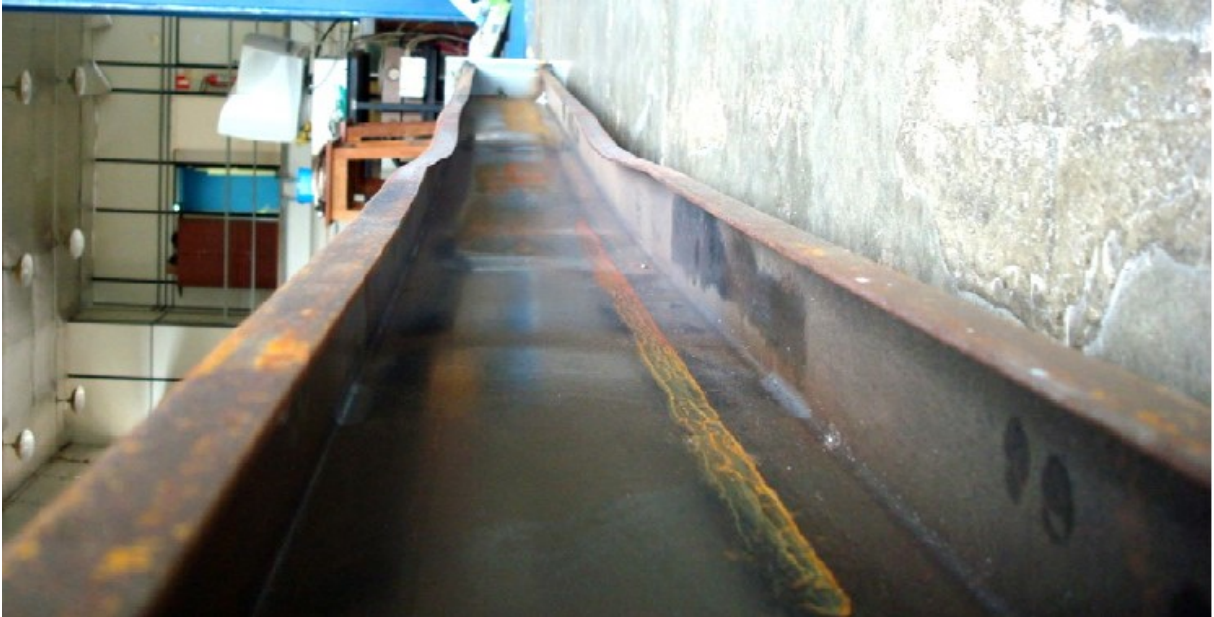
Figura 11 - Deformações no perfil I após ser submetido a temperaturas elevadas.
