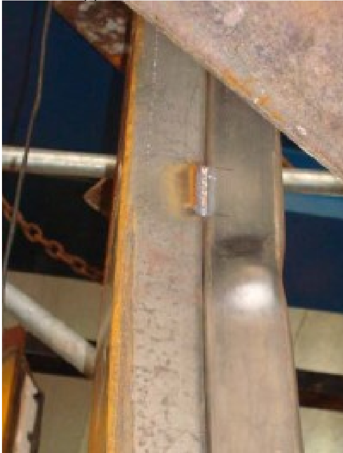
(a) Modo de falha local na alma
