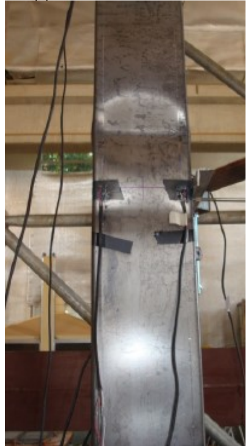
(b) Modo de falha local na mesa
