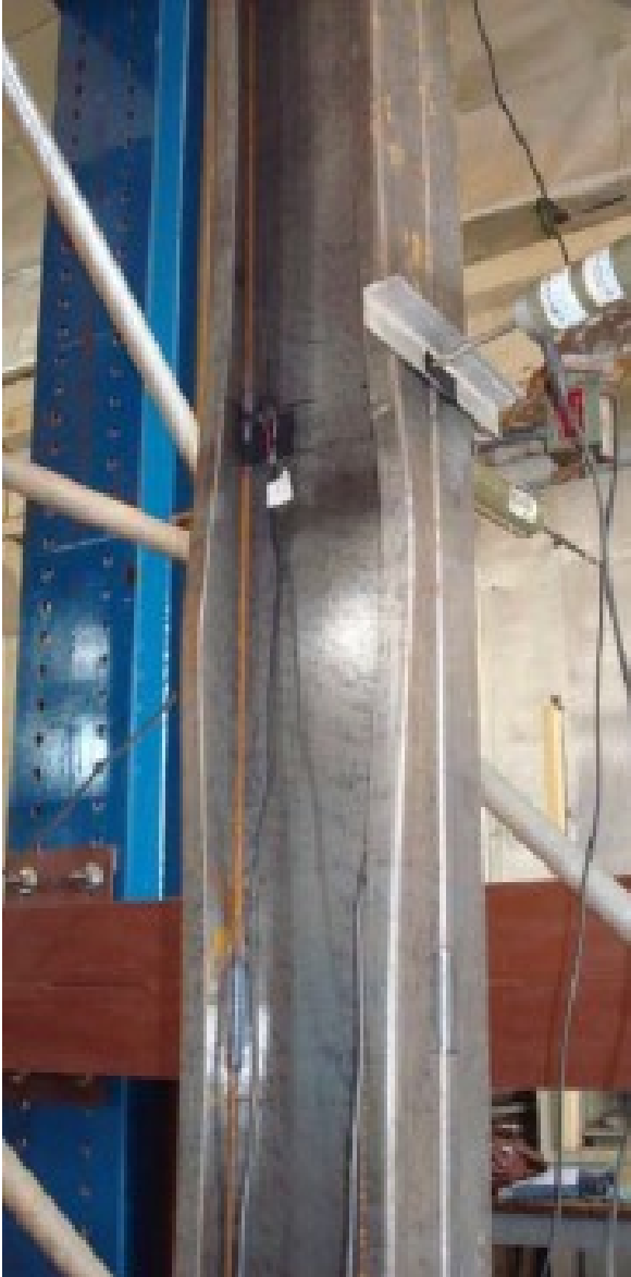
(a) Modo de falha local na alma e distorcional
