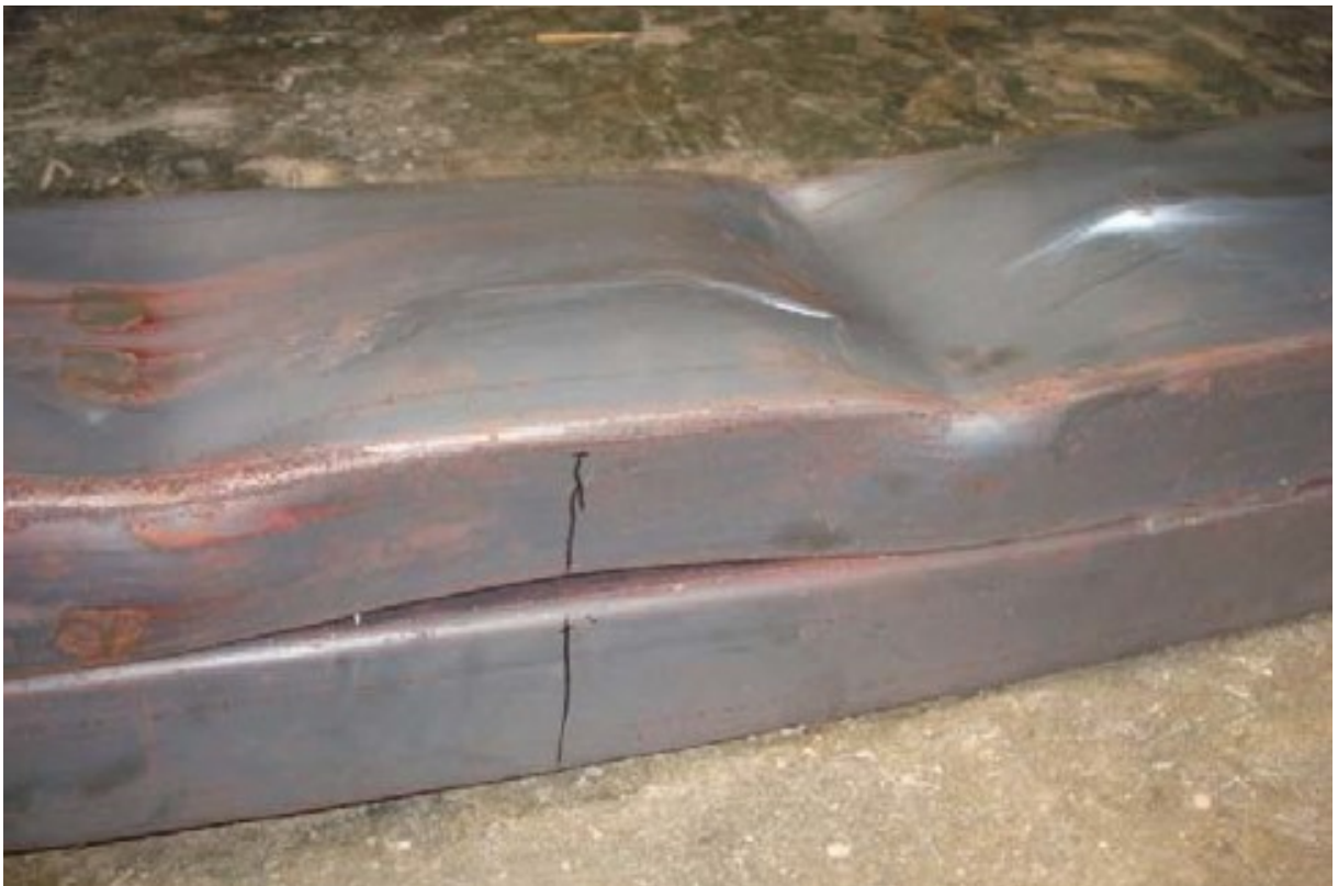
Figura 14 - Falha local na alma e na mesa e distorcional conjunto mesa-enrijecedor
