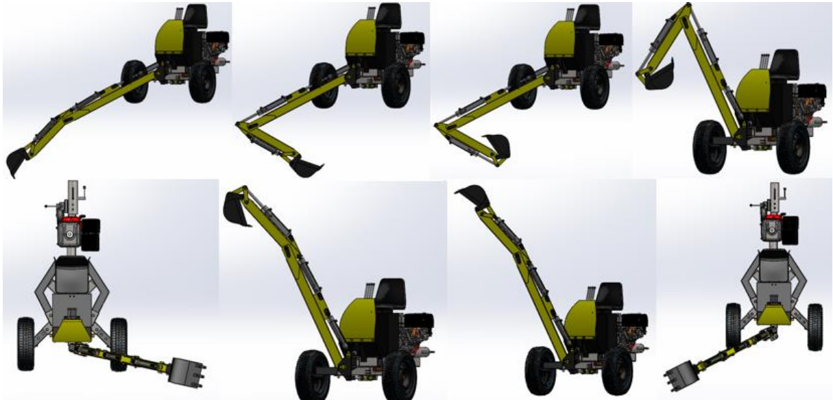
Figura 105 - Movimentos de escavação Fonte: O autor.
