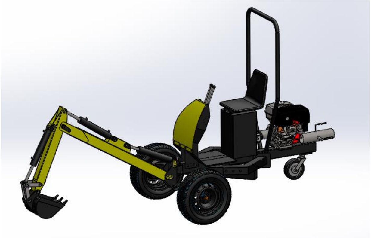
Figura 23 - Croqui da mini escavadeira no modo de transporte Fonte: O autor.
