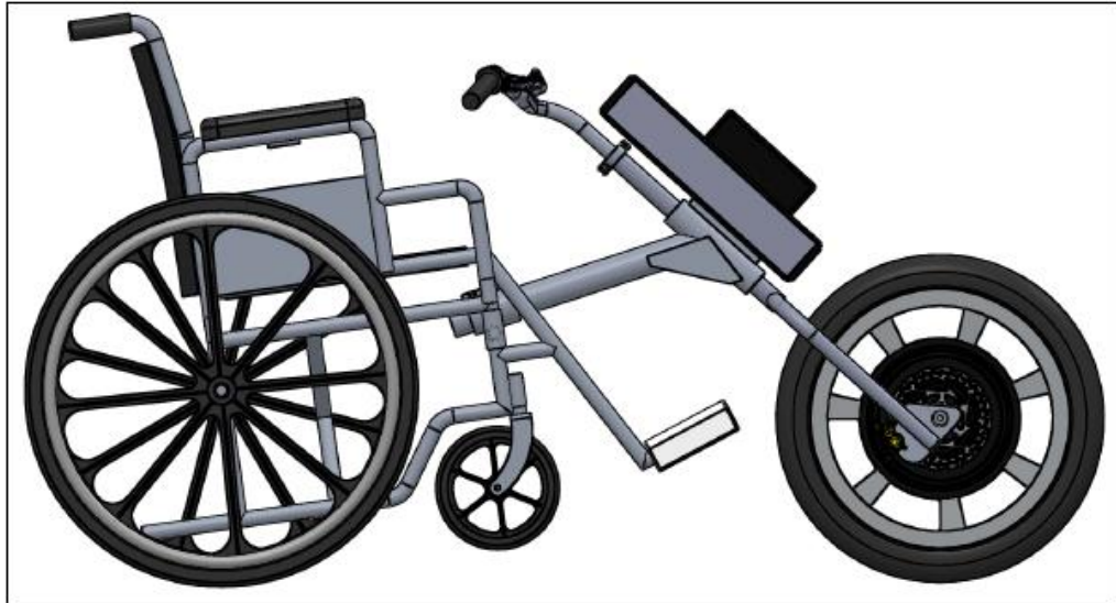
Figura 53 – Unidade de tração acoplada na cadeira de rodas Fonte: Autoria própria.
