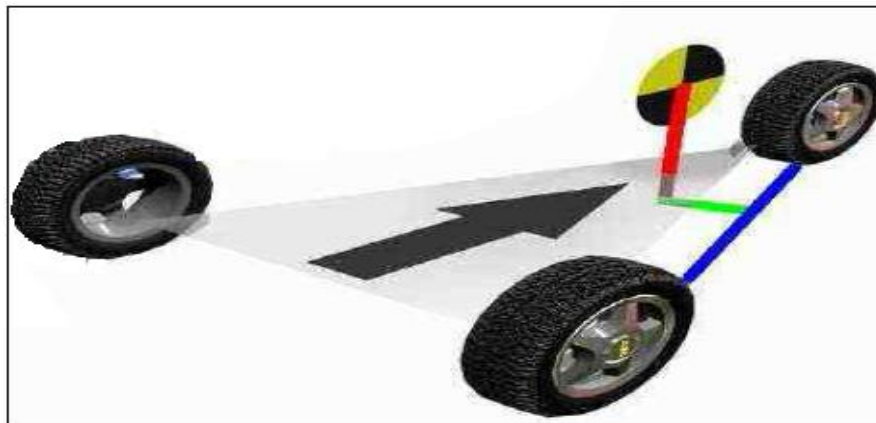
Figura 10 – Representação da linha de capotamento e da altura do centro de massa Fonte: Patodi, Saxena e Rathore (2013).
