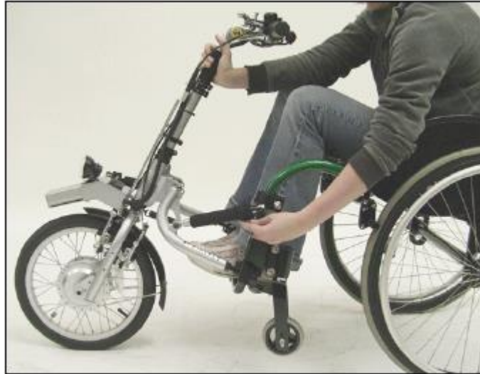
Figura 31 – Engate do braço superior Fonte: Manual do usuário Firefly electric handcycle .
