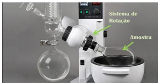
**Figura 15** – Rota-evaporador.
