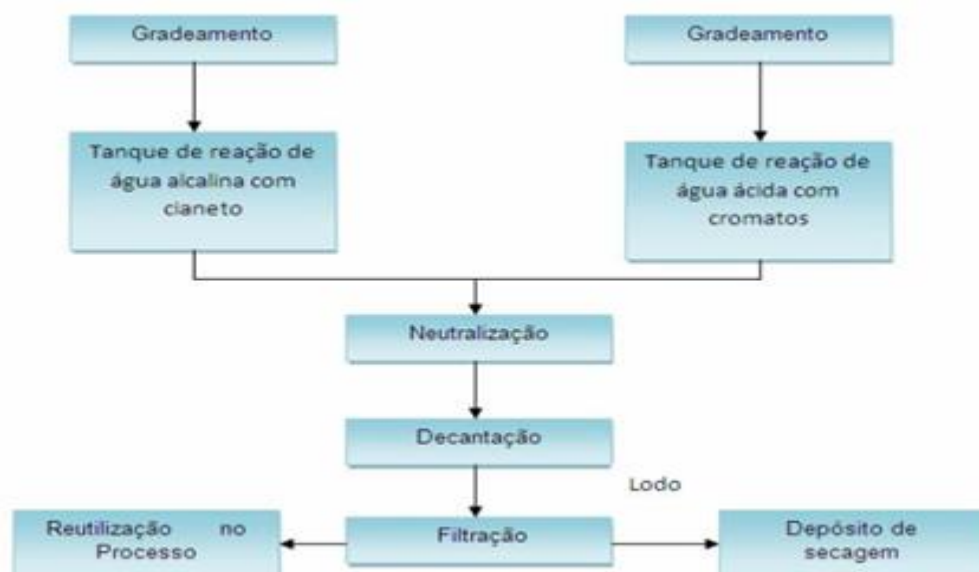
Figura 2 – “Fluxograma de tratamento de resíduo de galvanoplastia dimensionado por tanques de tratamento”
