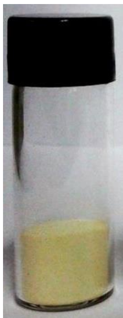
Figura 13 - Óxido de cério ( \text{CeO}_2 ) sintetizado pelo método de Pechini. Fonte: BRACKMANN (2016).
