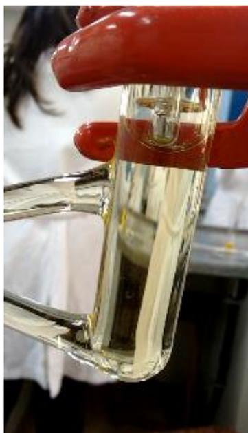
**Figura 17. Ponto de fusão em microescala (Tubo de *Thiele*)**
