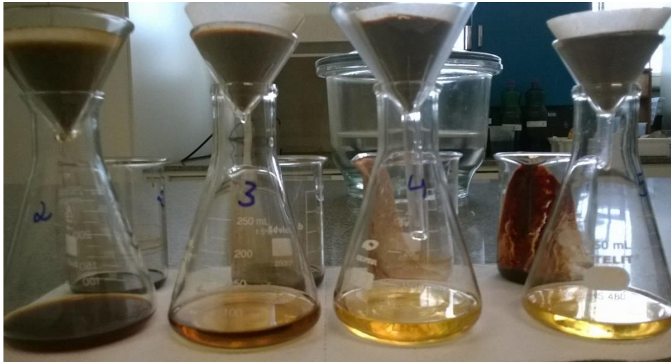
Figura 14 - Filtração do Efluente tratado. Fonte: própria.
