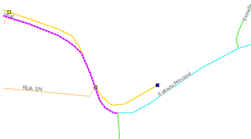
Figura 34 - Estradas sobrepostas sem nenhuma união entre si
