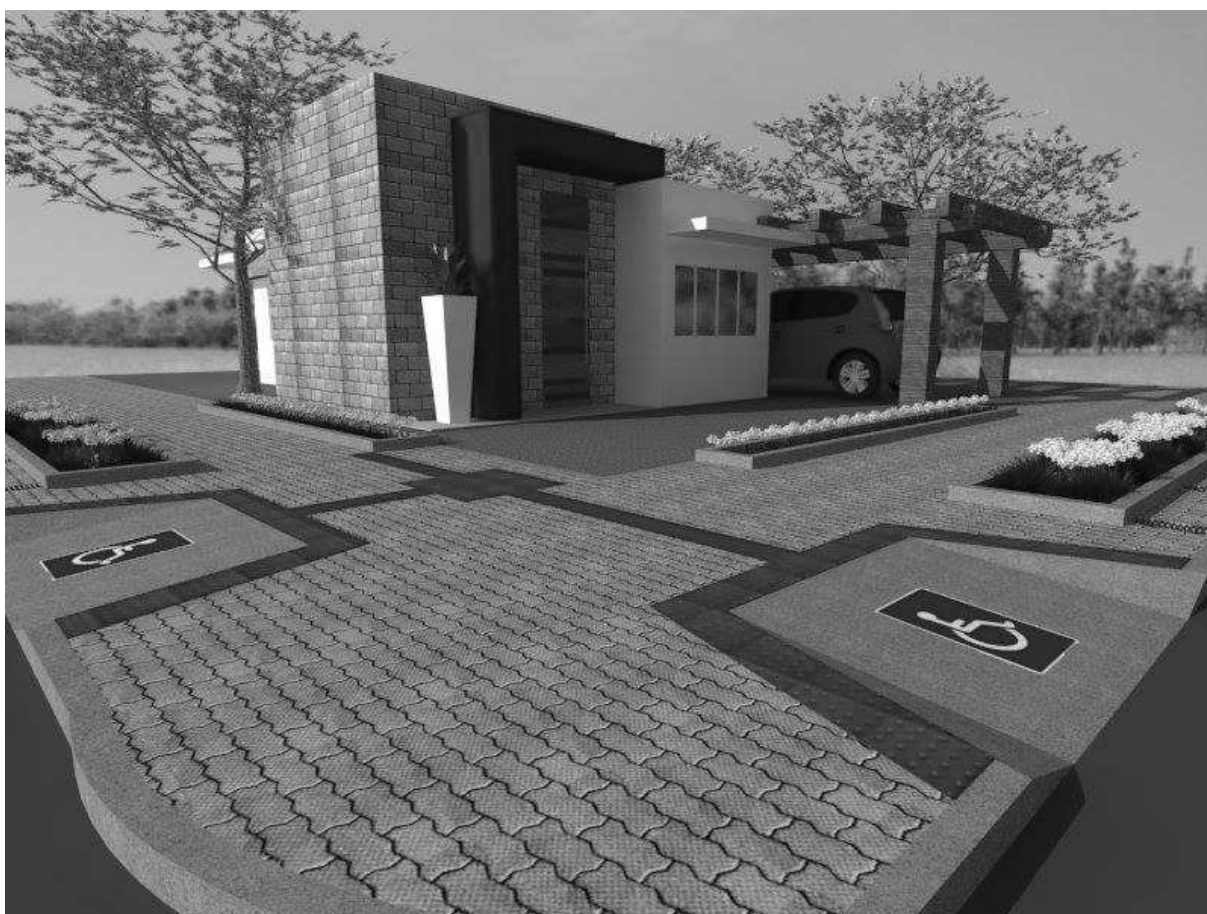
Figura 43 - Simulação de implementação de um jardim de chuva em calçada de esquina de 3,50 a 3,99 metros, de uso residencial.
