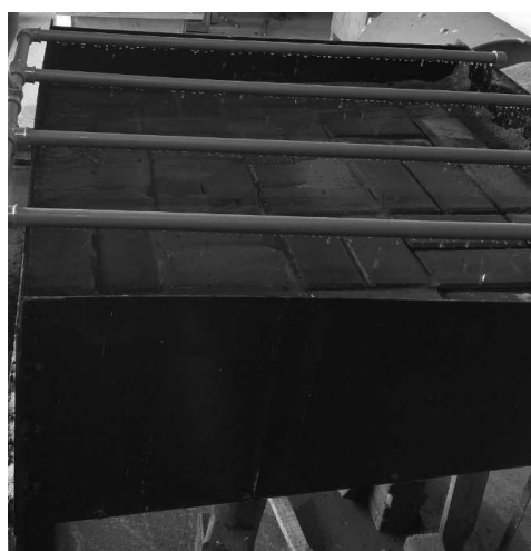
Figura 28 - Paver recebendo a precipitação. Fonte: Autor (2017).
