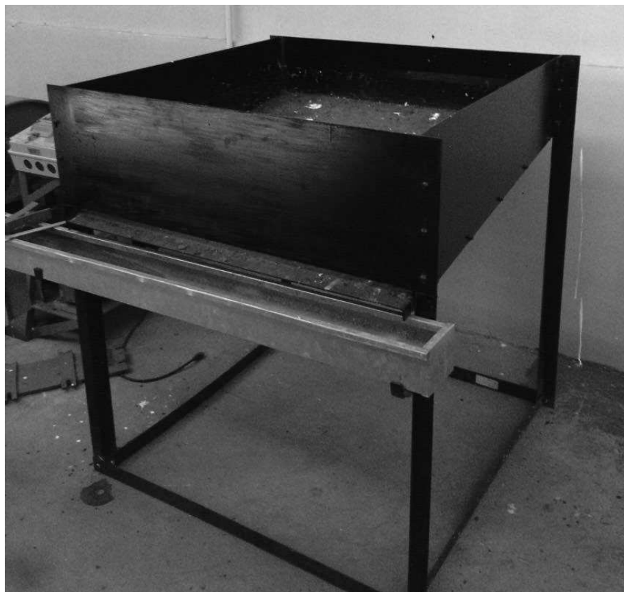
Figura 16 – Esquematização da estrutura idealizada que recebeu o jardim de chuva. Fonte: Autor (2016).
