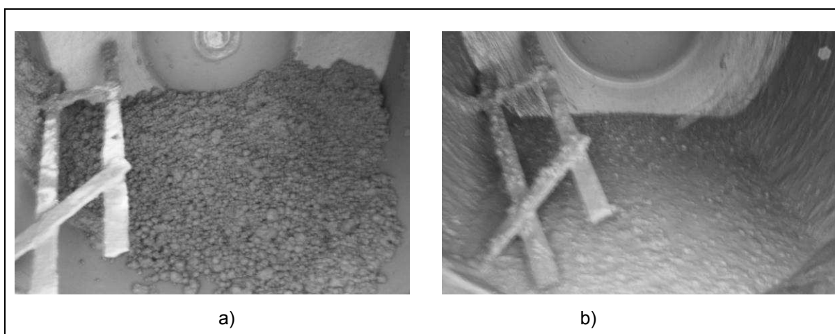
Figura 6- Comparação entre a mistura antes (a) e depois (b) da adição de superplastificante.
