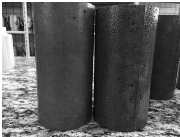
Figura 13- Comparação entre o concreto com aditivo e um concreto convencional.
