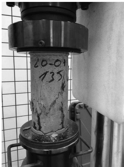
Figura 10- Corpo de prova submetido a ensaio mecânico em máquina Universal.
