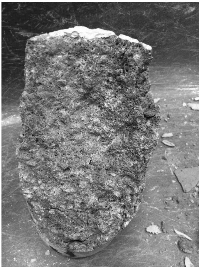
Figura 12 – Porosidade no interior do corpo de prova.
