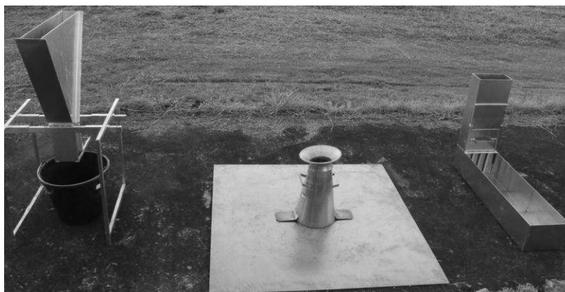
Figura 8- Funil-V, Slump flow e Caixa L, confeccionados para realização dos testes.
