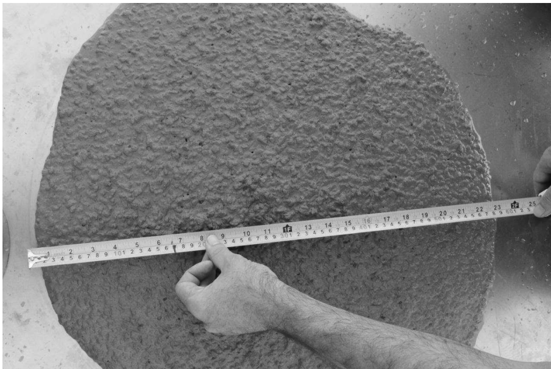
Figura 5- Medida do slump flow .
