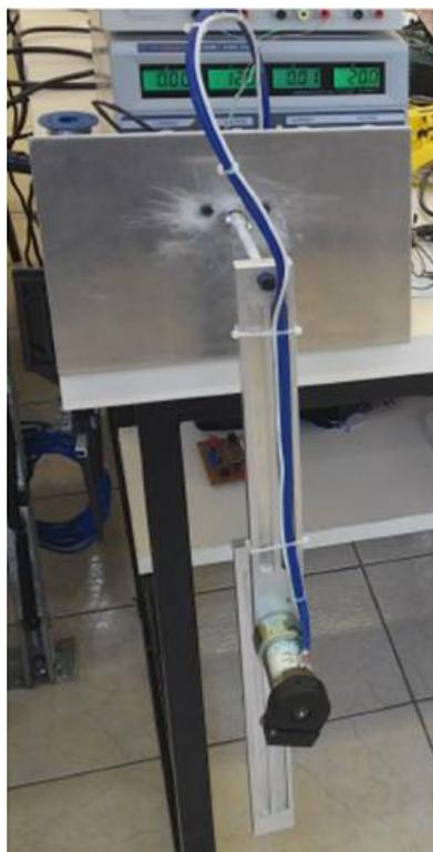
**Figura 39 – Protótipo do manipulador robótico**
